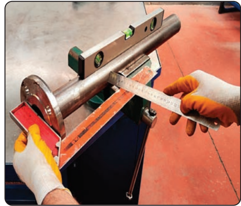
Görsel 1.15: Flanşın gönye ile kontrolü
