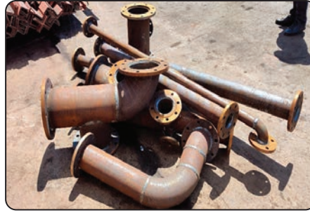
Görsel 2.9: Kaynağı yapılan spoollar
