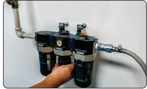
Görsel 4.18: Şartlandırıcı ayar vidası vasıtasıyla test basıncının ayarlanması
