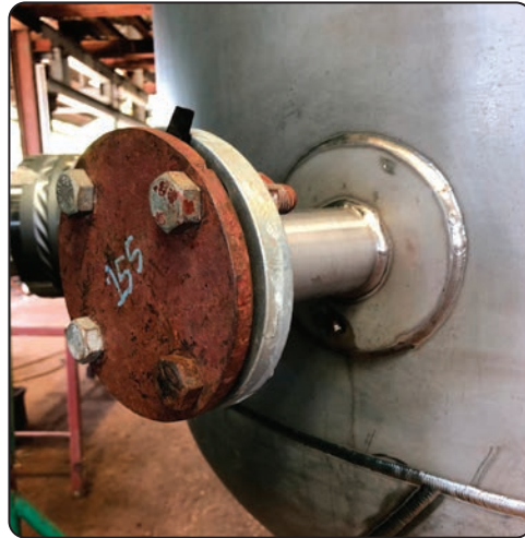
Görsel 1.19: Flanşlı borunun güçlendirme sacı ile tanka kaynatılmış hâli
