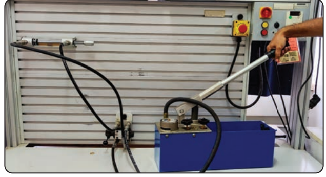
Görsel 3.27: Hidrostatik test pompası ile devre sızdırmazlık testi
