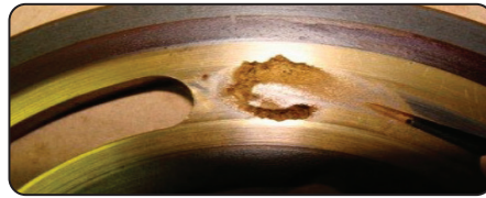
Görsel 3.1: Kavitasyonun sebep olduğu aşınmış devre elemanı
