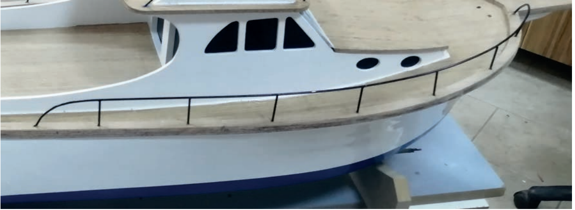
Görsel 8.1: Küpeşteye monte edilmiş vardavela
