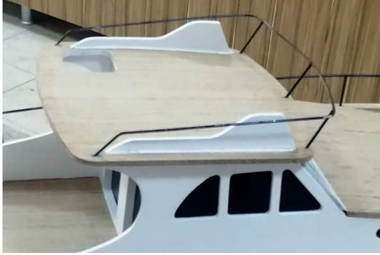
Görsel 8.2: Üst binaya monte edilmiş vardavela
