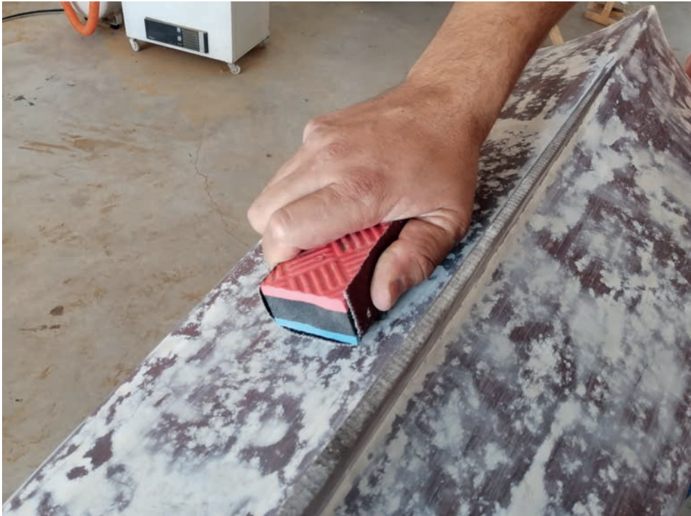
Görsel 7.1: Macunlanmış yüzeyin zımpara makinesi ile zımparalanması
