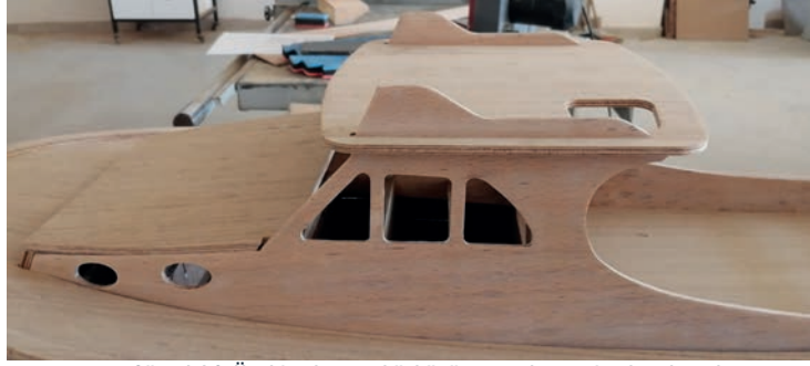
Görsel 6.9: Üst bina kaptan köşkünün parçalarının imalata hazırlanması
