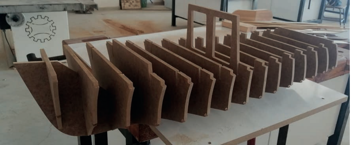
Görsel 3.7: İskelet bloklarının tutkallanarak yerlerine yapıştırılması
