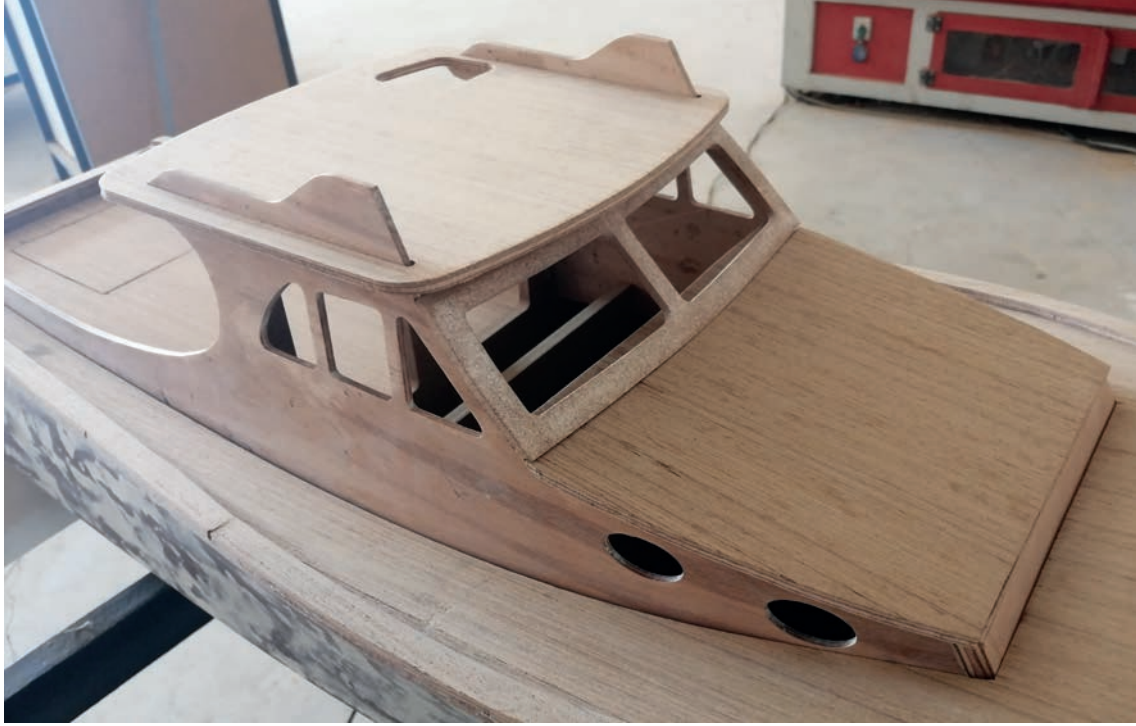
Görsel 6.5: Üst bina ve kaptan köşkünün güverte üzerine montajı
