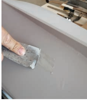
Görsel 7.7: Maket yüzeyine astar boya ve macun uygulanması
