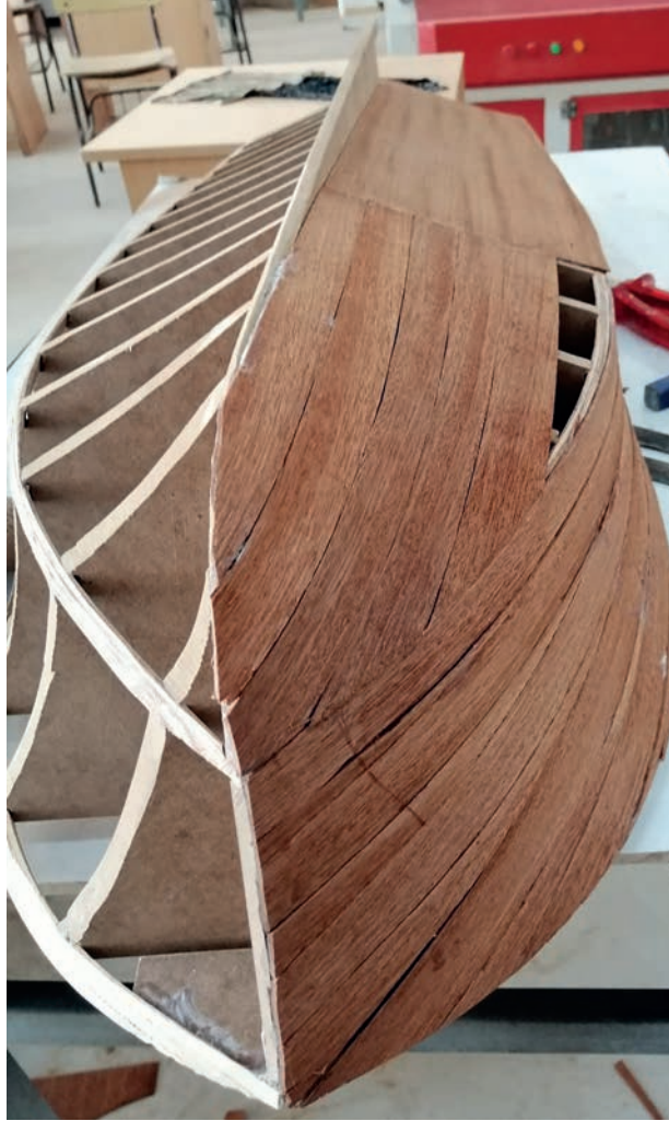
Görsel 4.3: Kaplamaların ıstralya-stringer ve küpeşte kuşağına birleştirilmesi
