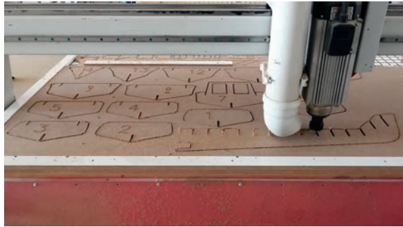
Görsel 2.8: CNC makinesinde parça kesimi
