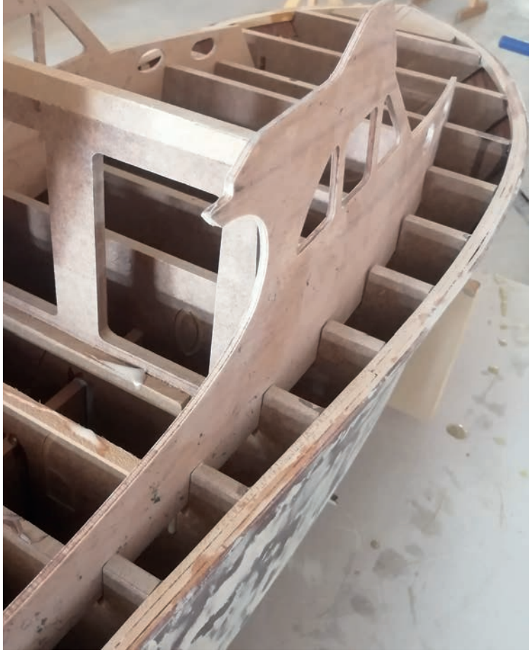
Görsel 6.2: Üst bina yan parçalarının yerlerine alıştırılması
