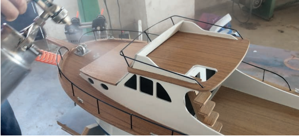
Görsel 7.8: Güverteye vernik uygulaması
