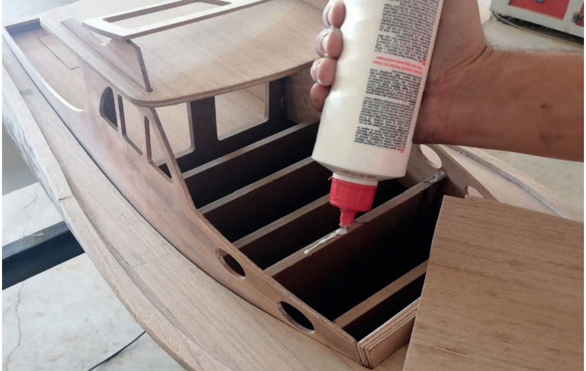
Görsel 6.4: Üst bina elemanlarının yapıştırılması
