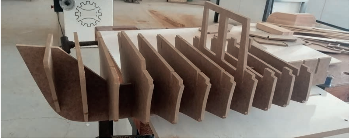
Görsel 3.6: Maket bloklarının yapıştırma işleminden önce yerlerine alıştırılması
