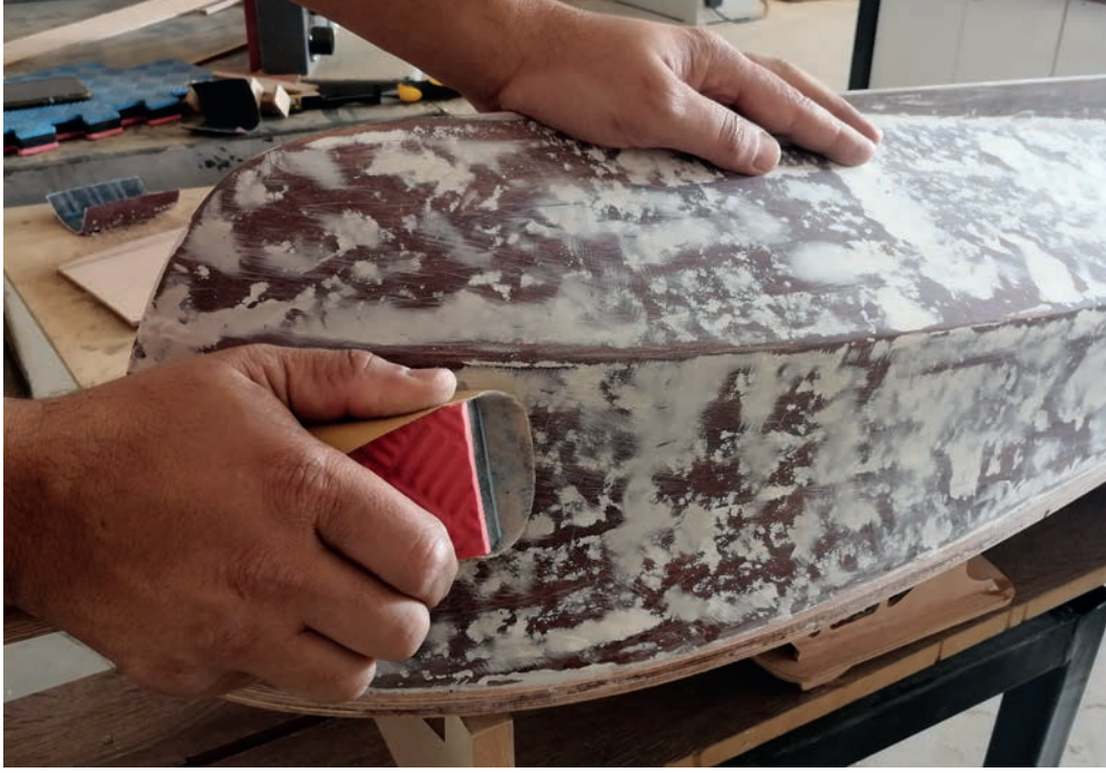
Görsel 7.2: Yüzeyin kauçuklu zımpara takozu ile zımparalanması
