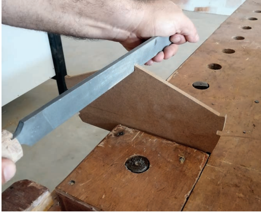
Görsel 3.2: Posta üzerindeki omurga boşluğunun eğe ile temizlenmesi
