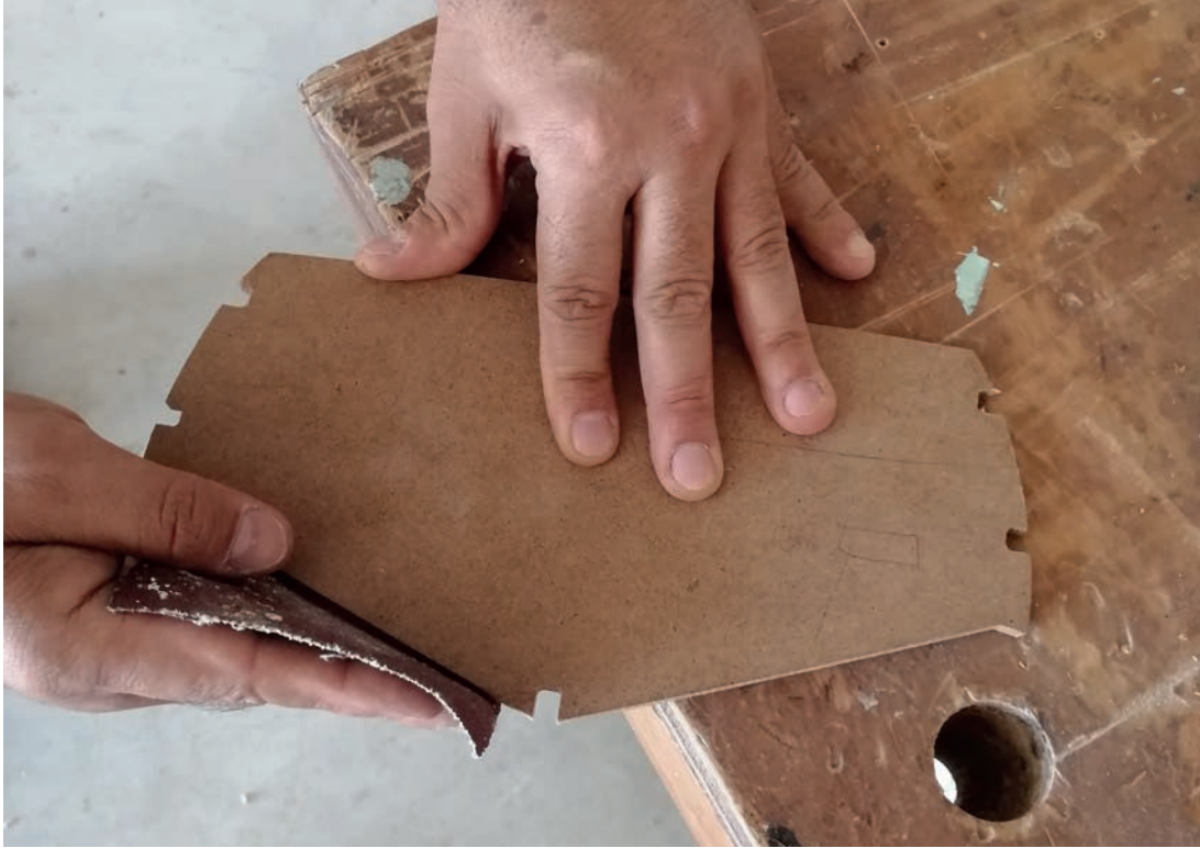
Görsel 3.1: Postanın zımpara ile temizlenmesi
