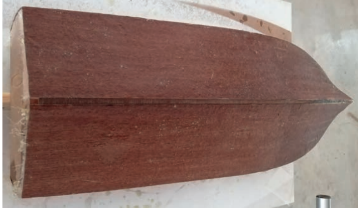
Görsel 4.15: Maket yüzeyinin epoksi ve elyaf ile kaplanması
