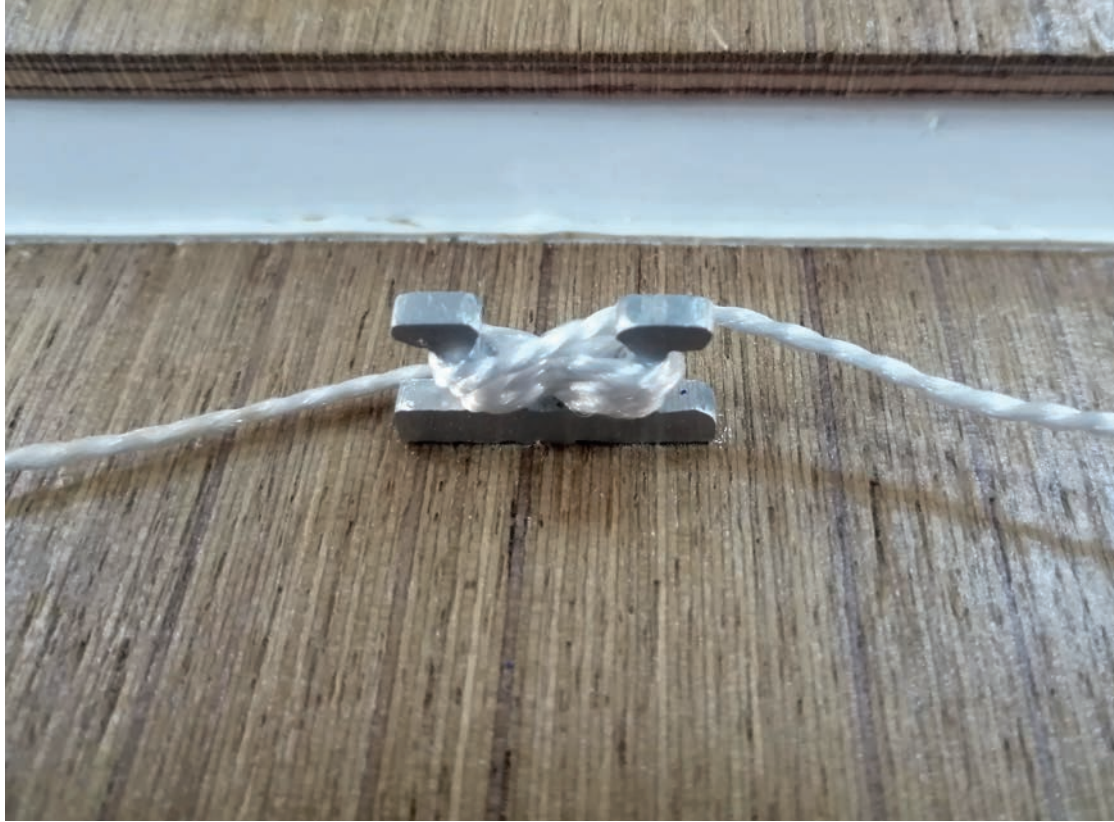
Görsel 8.11: Babanın güverteye montajı
