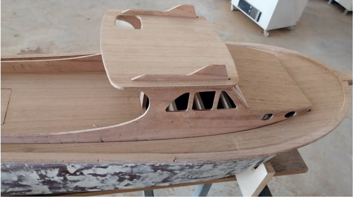
Görsel 6.10: Üst bina ve kaptan köşkünün montajı
