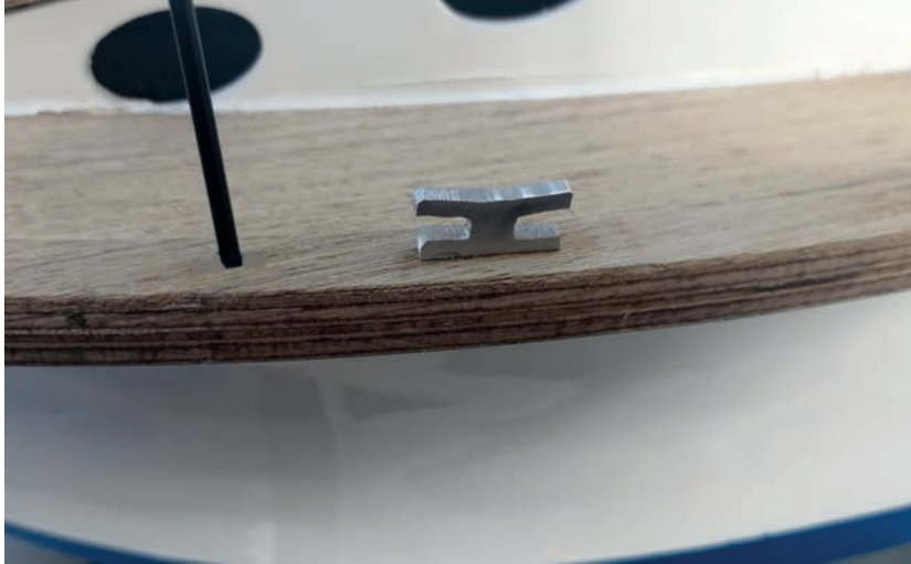
Görsel 8.10: Koçboynuzlarının küpeşteye montajı
