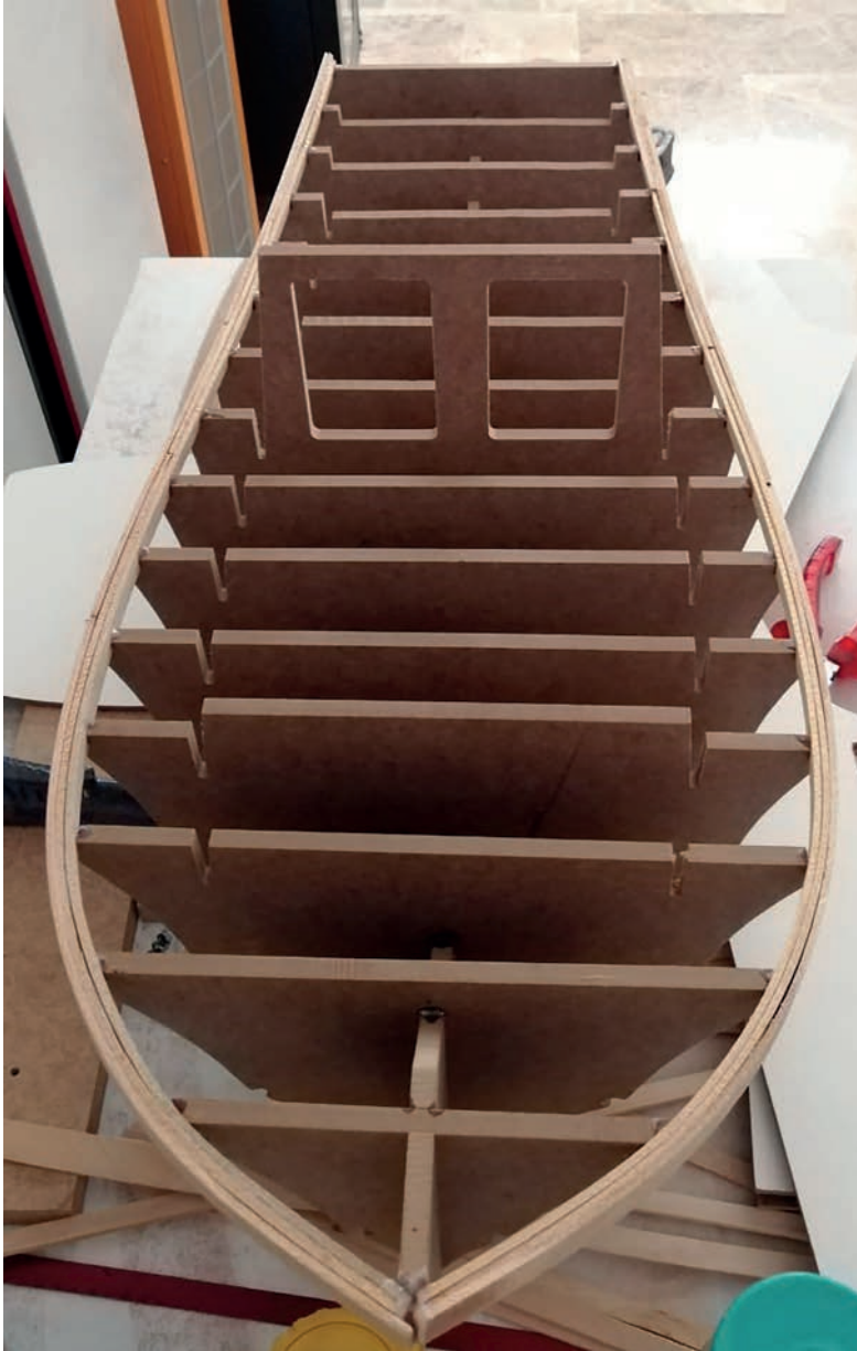
Görsel 3.10: İstralya kuşaklarının montajı
