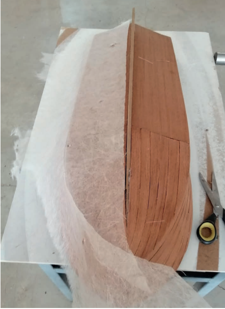
Görsel 4.11: Dış kaplamanın tül elyafının ayarlanması
