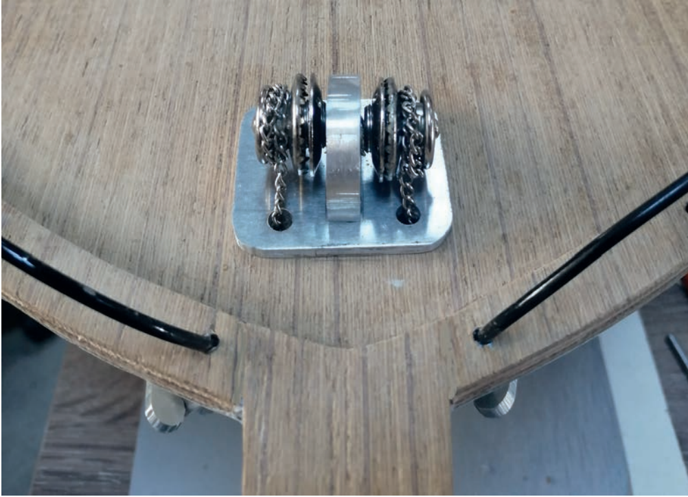
Görsel 8.7: Montajı yapılmış ırgat
