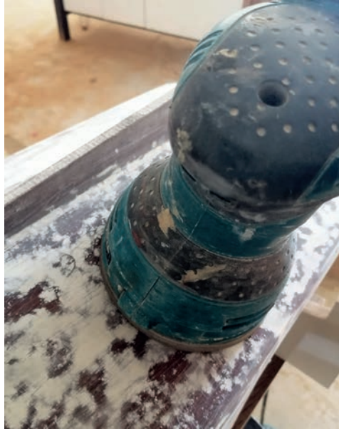
Görsel 4.14: Macunlu yüzeyin makine ile zımparalanması
