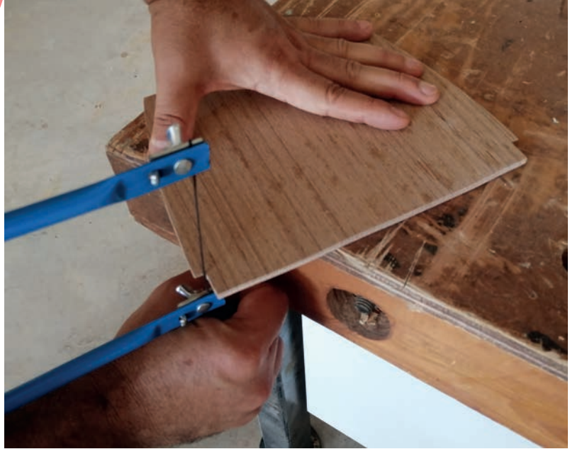
Görsel 2.1: Kıl testere ile kesim
