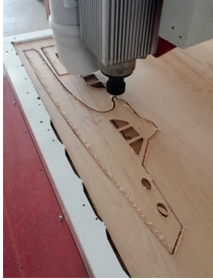
Görsel 2.10: Üst bina elemanlarının CNC makinesiyle kesimi
