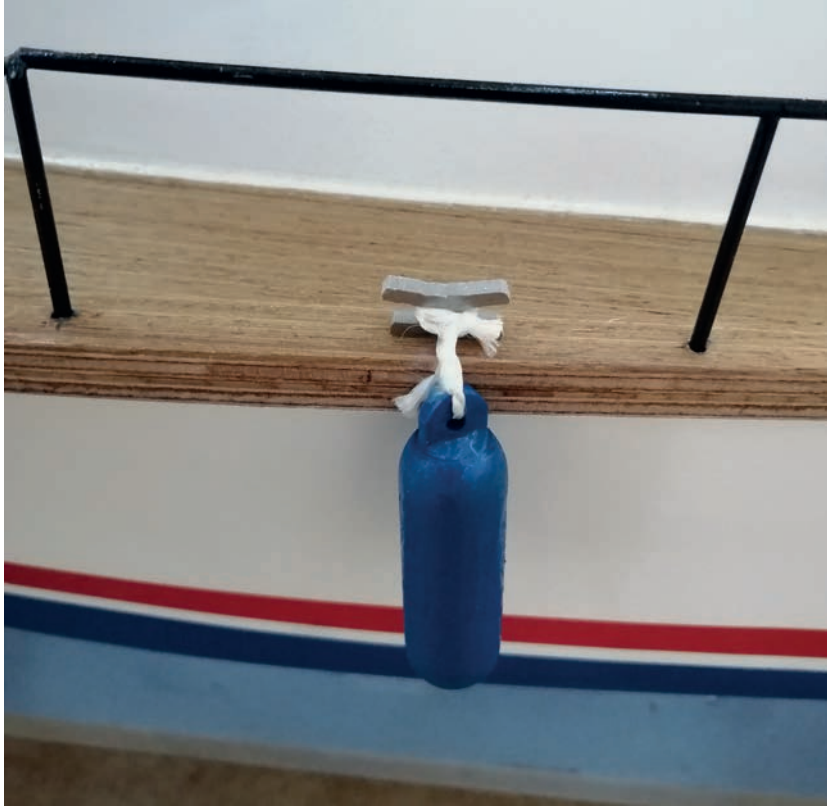
Görsel 8.13: Koçboynuzunun küpeşteye montajı
