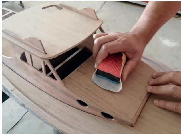
Görsel 7.4: Üst binanın kauçuklu zımpara takozu ile zımparalanması
