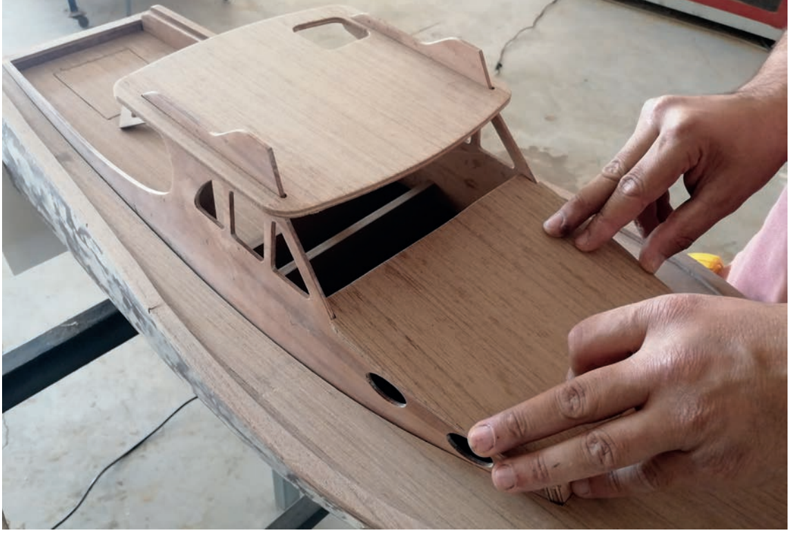
Görsel 6.3: Üst bina parçalarının yerlerine alıştırılması
