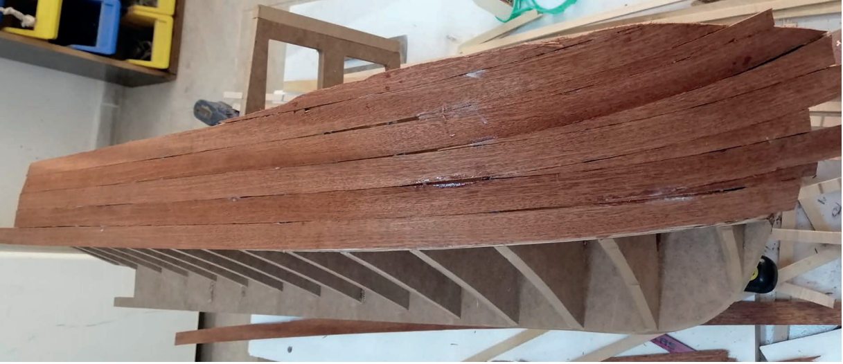
Görsel 4.7: Maket bordasının dış kaplaması
