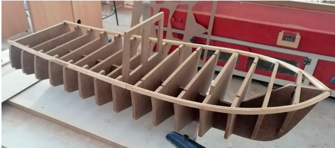
Grsel 3.9: İstralyaların yerlerine montajı
