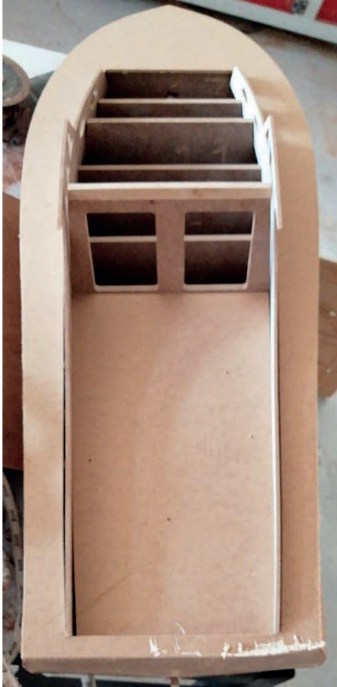
Görsel 5.8: Güverte zemininin montajı
