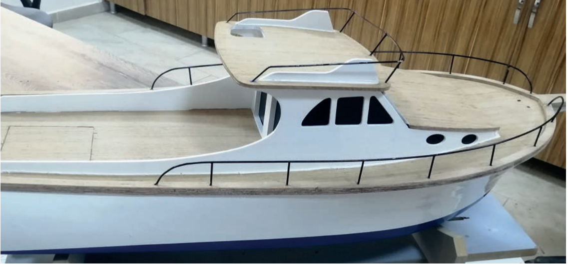
Görsel 8.3: Montajı yapılmış vardavela
