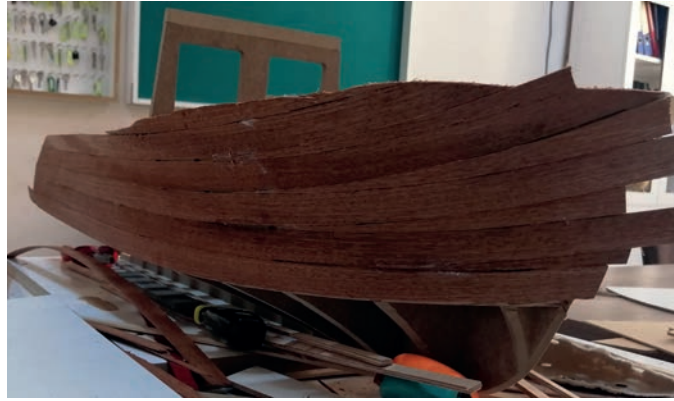
Görsel 4.5: Kaplamaların arasındaki boşlukların kapatılması
