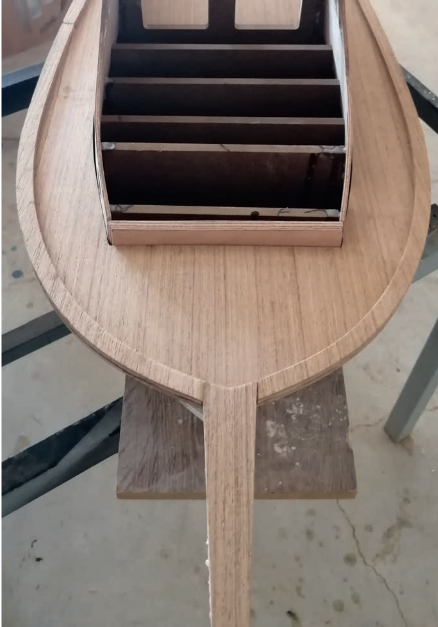
Görsel 5.11: Küpeşte ve bastonun güverteye ve posta uçlarına montajı
