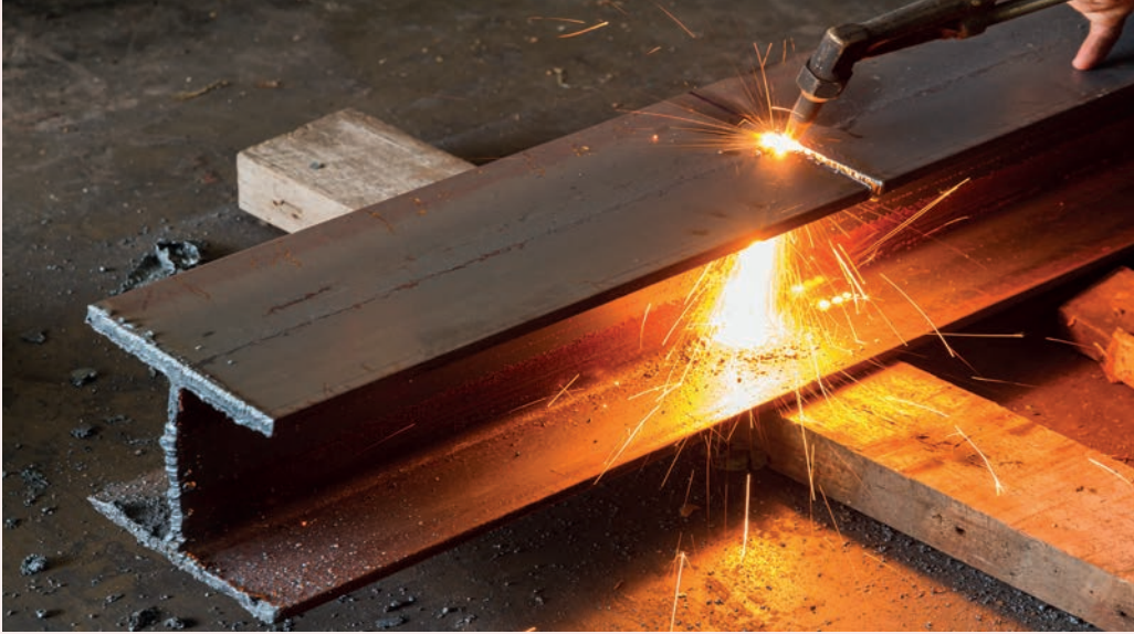
Görsel 7.8: Kalın profillerin oksi-gaz yöntemiyle kesilmesi
