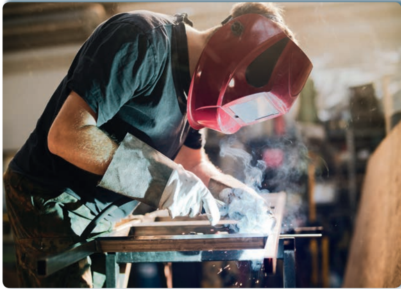
Görsel 1.5: Kaynak yapılacak parçanın sabitlenmesi
