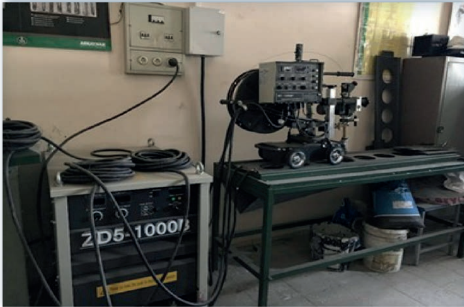
Görsel 5.4: İnce malzemelerin tozaltı kaynak makinesi ile kaynatılması
