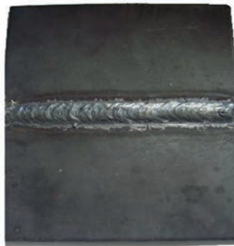
Şekil 2.8: Küt ek puntalama aralığı ve dikişi
