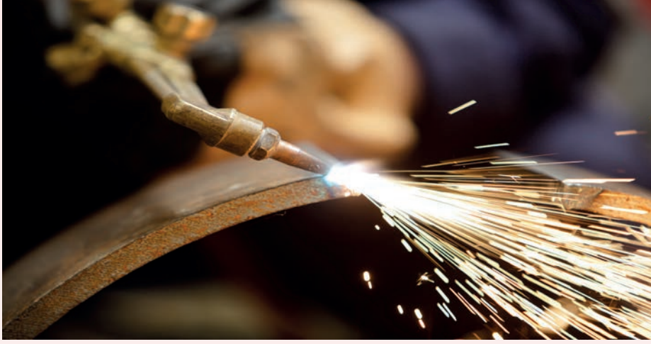
Görsel 7.10: Gemi sacını oksî-gaz yöntemiyle 45 derecelik eğim ile kesme
