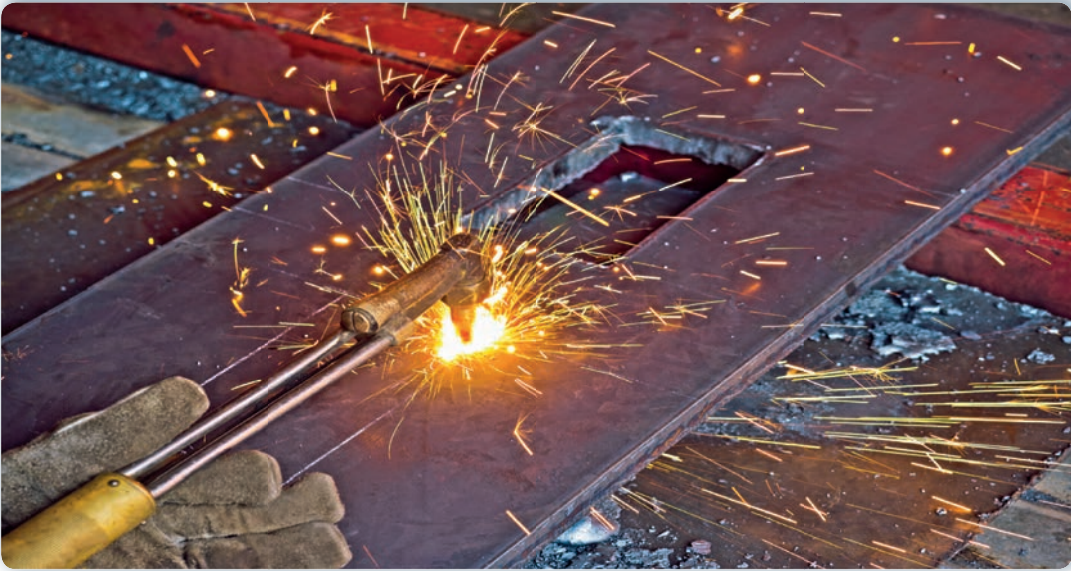
Görsel 7.4: Oksi-gaz ile kesmede 90 derecelik dik açı
