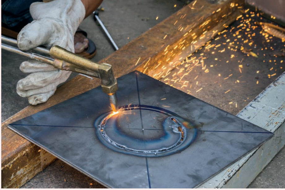
Görsel 7.9: Sac levhaların oksi-gaz yöntemiyle dairesel kesimi
