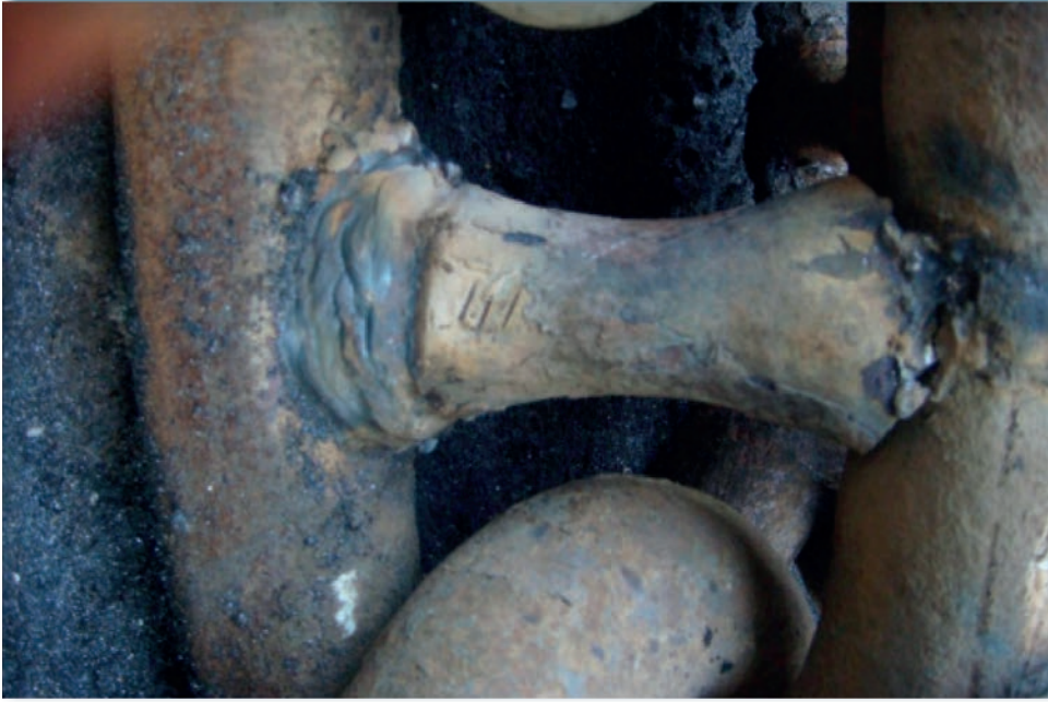
Görsel 2.15: Gemi zincir lokması hatalı kaynak uygulaması
