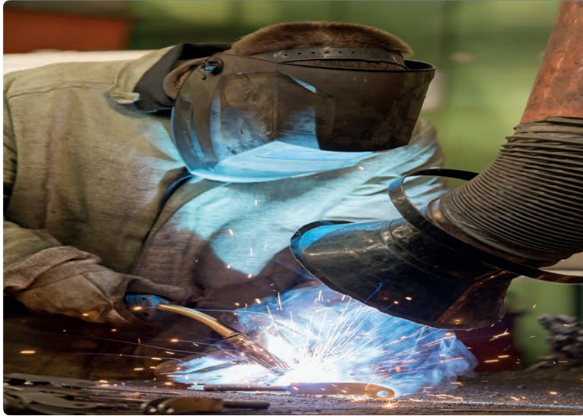
Görsel 1.7: Kaynak sırasında aspiratör kullanımı
