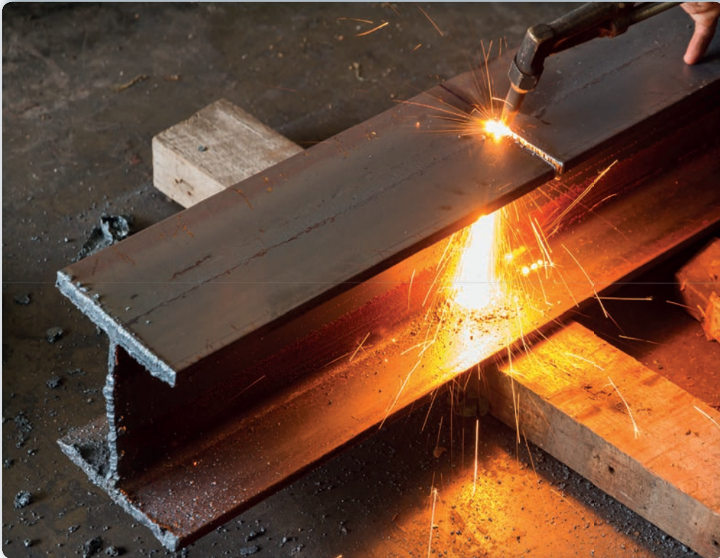
Görsel 7.3: Oksi-propan ile düzgün kenarlı kesim
