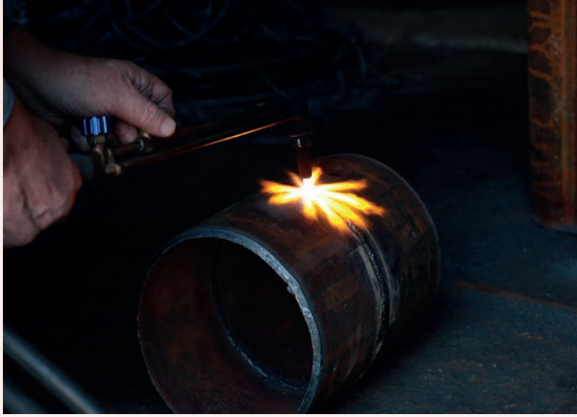
Görsel 7.7: Çelik boruların oksi-gaz yöntemiyle kesilmesi
