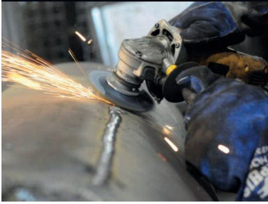
Görsel 8.13: a) Taşlama yöntemi ile yüzey temizleme
