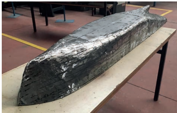
Görsel 3.28: Taşlama yapılmış yüzeyler
