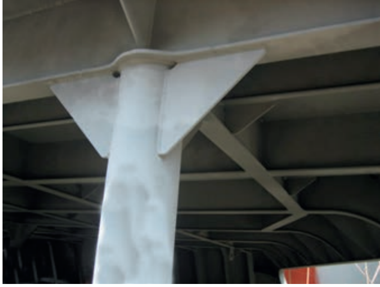
Görsel 3.5: Gemi güvertesi altında dikme (puntel) uygulaması
