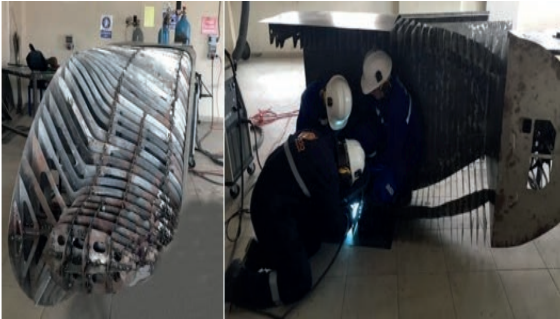
Görsel 3.29: Örnek orta blok montajı ve kaplaması
