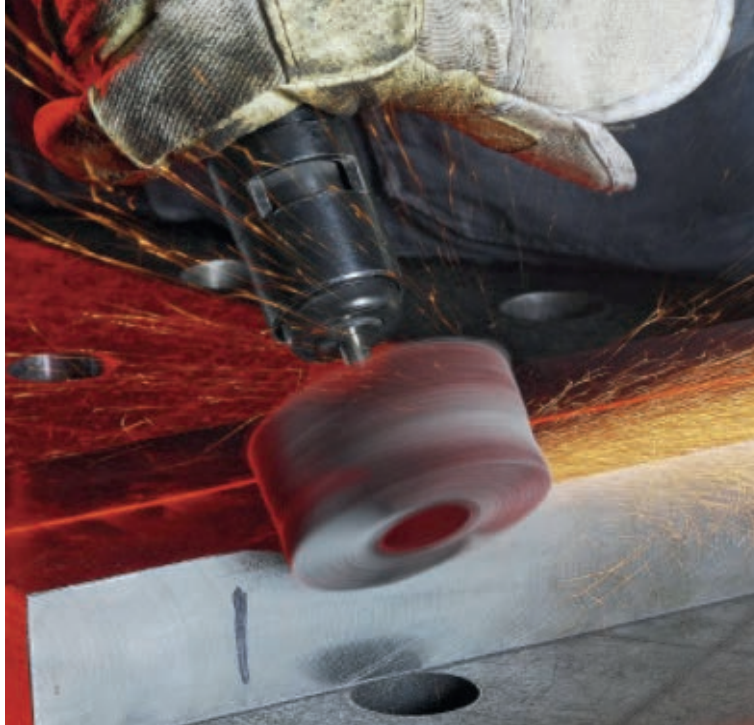
Görsel 8.15: Gravür ile yüzey temizleme
