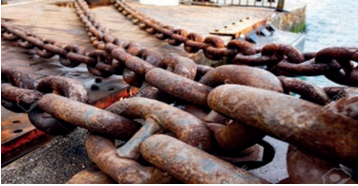
Görsel 2.15: Korozyona uğramış zincir
