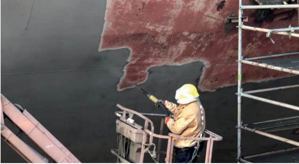
Görsel 8.6: Raspa ile boya söküm işlemi
