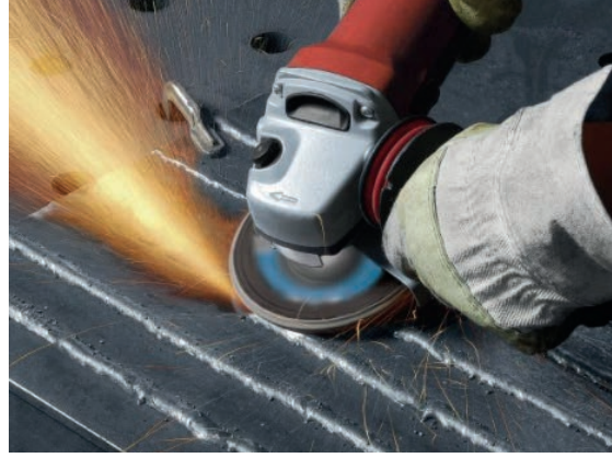
b) Flap disk ile yüzey temizleme
