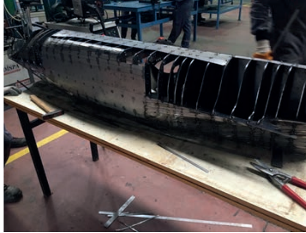
Görsel 3.26: Kaplamanın yapılması I
