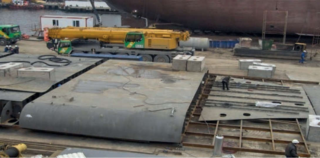
Görsel 1.16: Double bottom tankının sacının sarılması.
