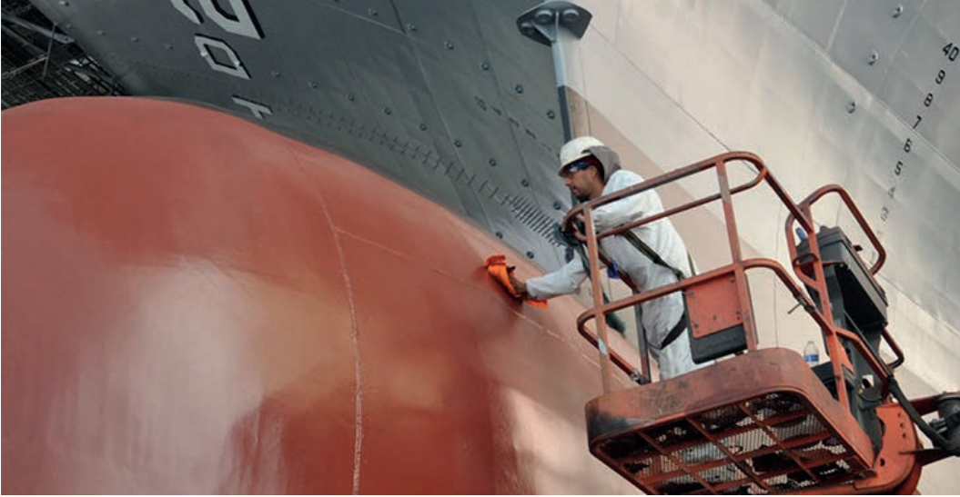
Görsel 8.2: Yüzey temizleme işlemi
