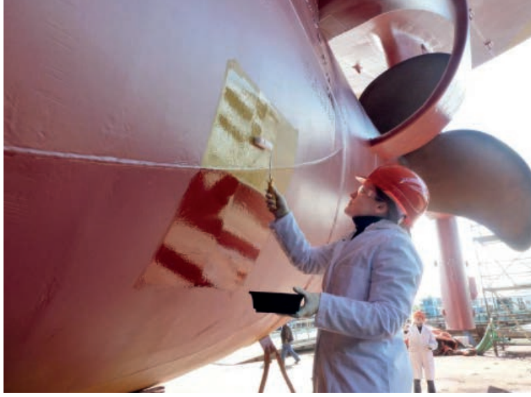
Görsel 8.44: Rulo ile boya uygulaması
