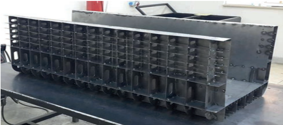
Görsel 3.2: Postaların döşeklere montajlanması
