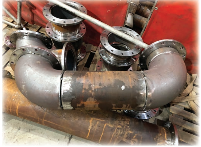
Görsel 8.7: Balast tesisatı boruları
