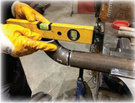
Görsel 6.19: Su terazisi ile açı kontrolü
