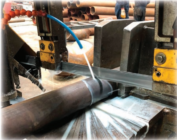
Görsel 1.24: Borunun elektrikli hidrolik testerede kesilmesi
