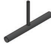
Şekil 2.2: Boru eklenmiş ana devre borusu
