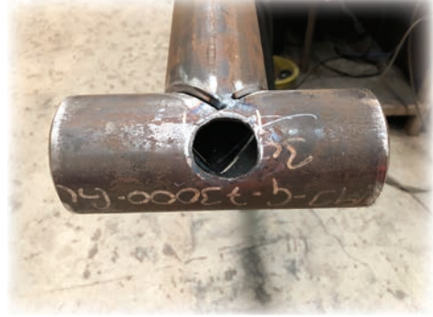
Görsel 2.19: Çapakları temizlenmiş ana boru
