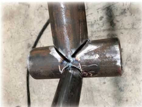
Görsel 2.22: Punta kaynağı ile birleştirilmiş borular
