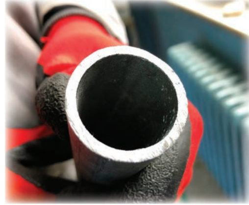
Görsel 1.12: Çapakları temizlenmiş galvanizli boru
