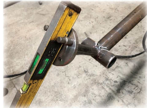
Görsel 2.21: Su terazisi ile açı kontrolü
