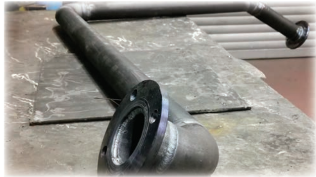
Görsel 7.10: İmalatı tamamlanmış ısıtma tesisatı devresi
