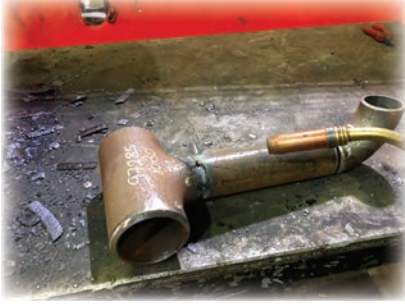
Görsel 5.13: MIG-MAG kaynağı
