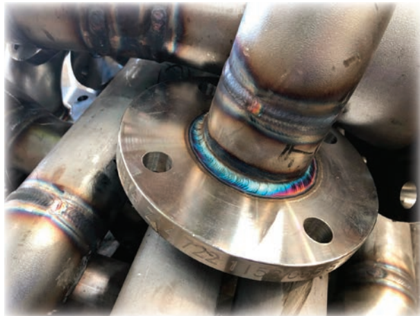
Görsel 1.31: Kaynak işlemi tamamlanmış boru
