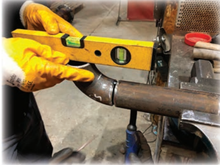
Görsel 5.9: İlk punta sonrası terazi kontrolü
