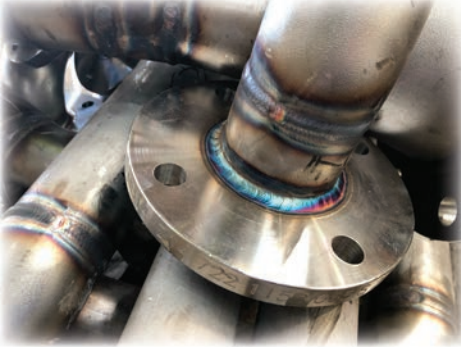
Görsel 6.10: Flanş kaynağı
