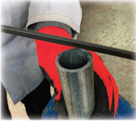
Görsel 1.11: Çapakların eğe ile temizlenmesi
