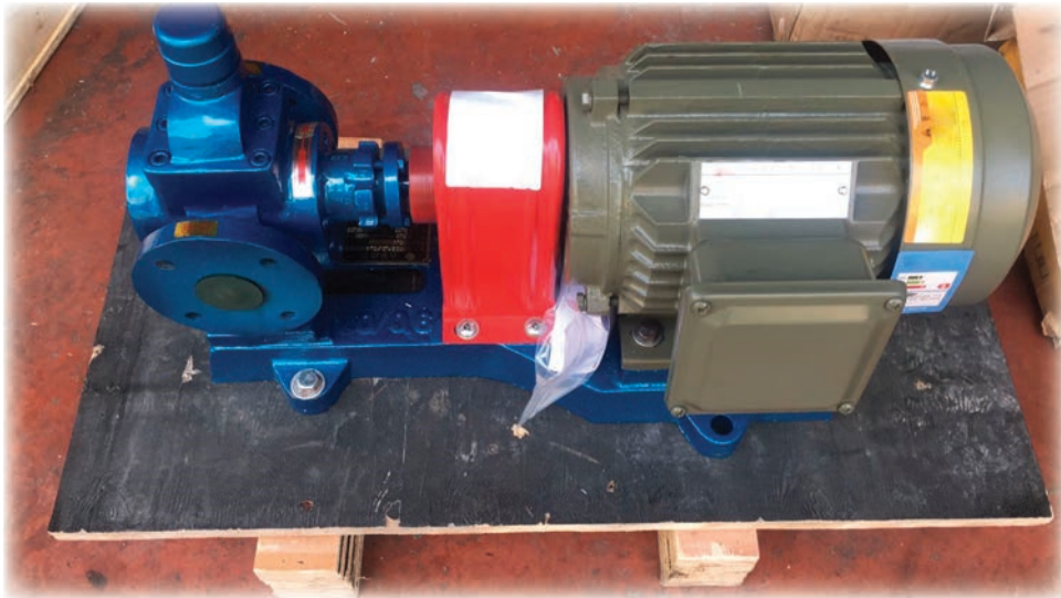
Görsel 7.20: Isı sirkülasyon pompası
