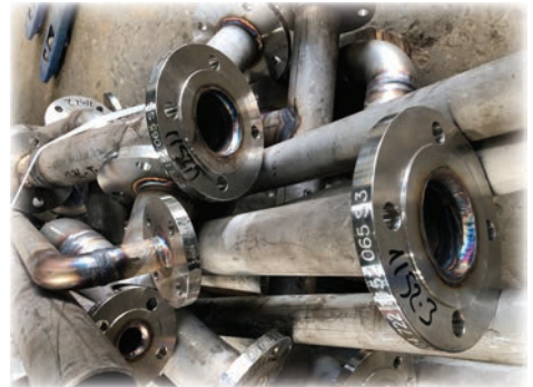
Görsel 6.11: İmalatı tamamlanmış temiz su tesisatı devreleri
