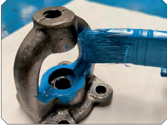
Görsel 2.122: Fırça ile boya uygulaması
