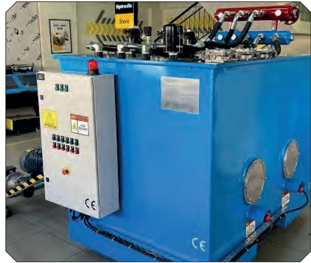
Görsel 4.49: Flushing (hidrolik yağ ile boru içi temizle) ünitesi
