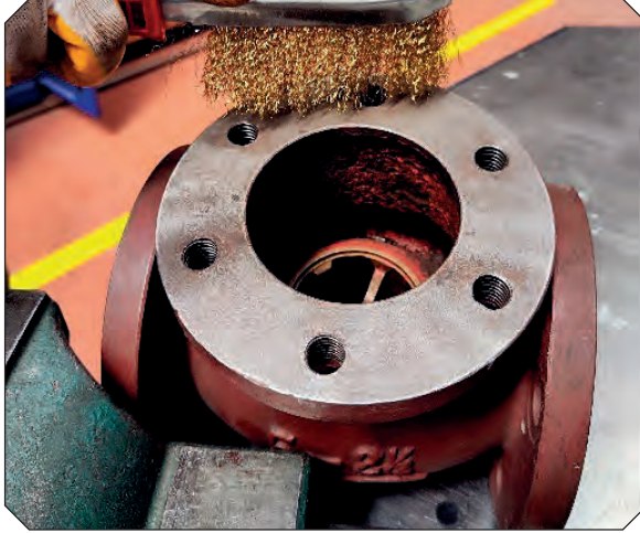
Görsel 2.162: Flanş yüzeyinin temizlenmesi
