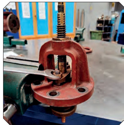
Görsel 2.91: Salmastra flanşının sökülmesi
