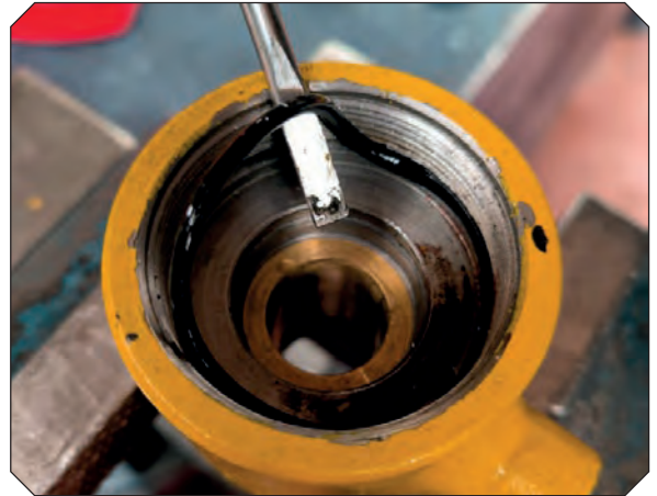
Görsel 4.82: Silindir boğazı o-ring çıkarma işlemi
