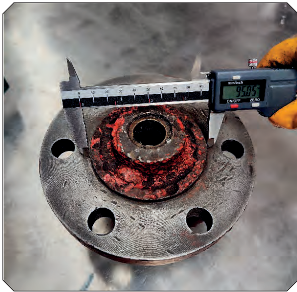
Görsel 2.156: İç çap ölçüsünün alınması
