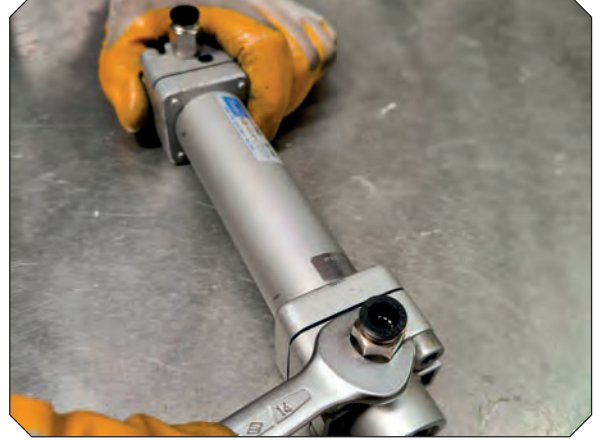
Görsel 4.114: Pnömatik silindir bağlantı noktası takma işlemi
