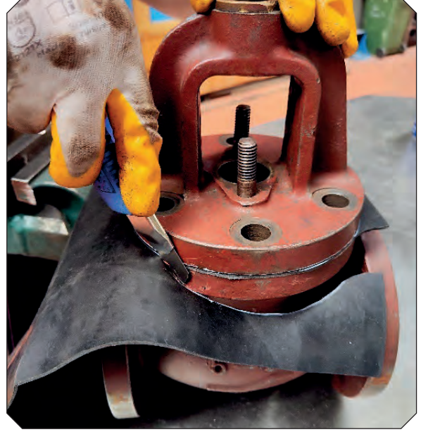
Görsel 2.159: Dış çap ölçüsünün kesilmesi
