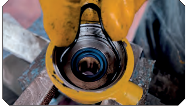
Görsel 4.84: Silindir boğazı o-ring takma işlemi
