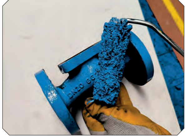
Görsel 2.123: Rulo ile boya uygulaması
