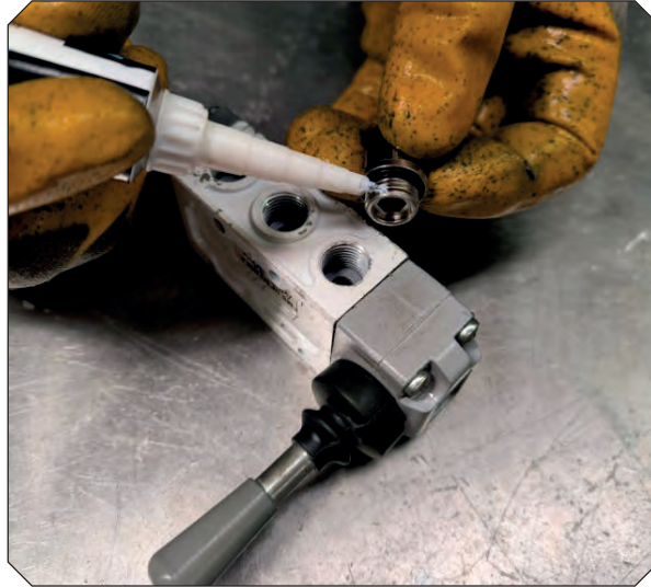
Görsel 4.103: Pnömatik bağlantı elemanı dişlerine sıvı conta sürme
