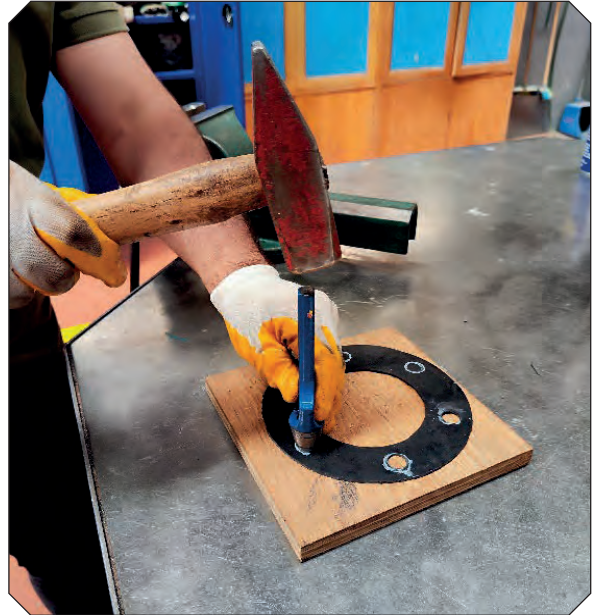
Görsel 2.161: Zımba ile deliklerin kesilmesi
