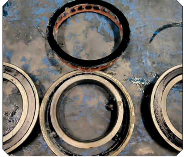
Görsel 3.57: Yetersiz yağlama sonucu dağılmış rulman
