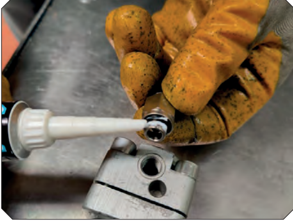
Görsel 4.113: Pnömatik silindir bağlantı noktası sıvı conta sürme işlemi
