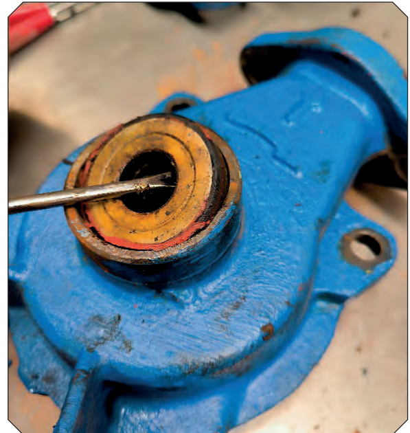
Görsel 3.27: Rulmanın çıkartılması
