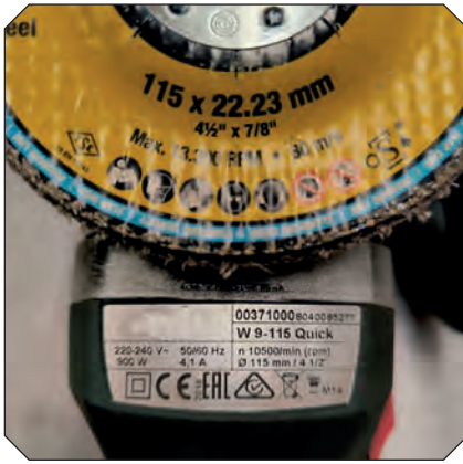
Görsel 2.99: Disk ve taşlama motorunun değerleri
