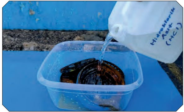
Görsel 3.34: Elemanların asite yatırılması
