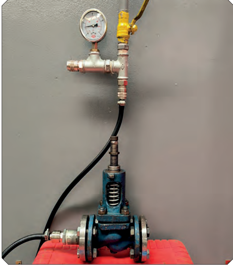
Görsel 2.177: Test ünitesine bağlanmış emniyet valfi
