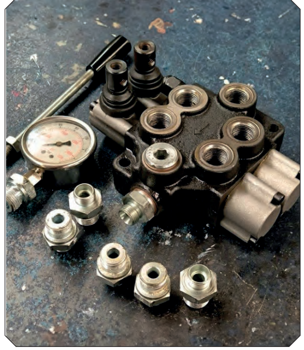
Görsel 4.53: Bağlantı noktaları sökülmüş valf
