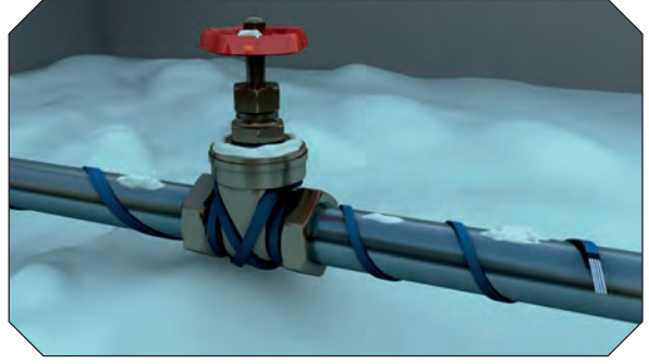
Görsel 1.22: Boru devresine harici ısıtma uygulanması
