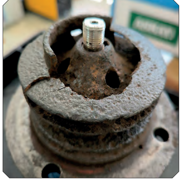
Görsel 3.21: Erozyon korozyonuna uğramış pompa çarkı
