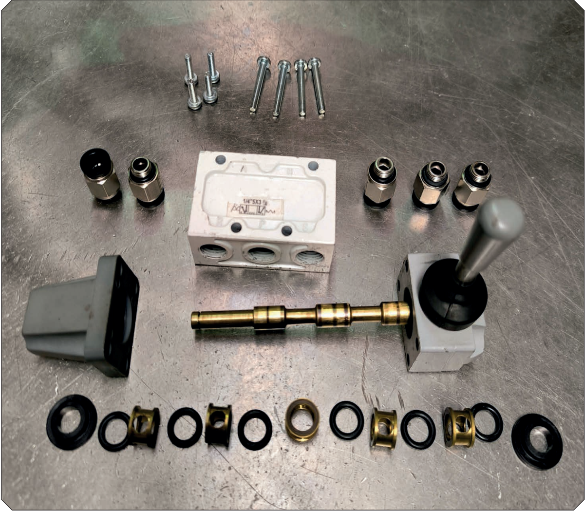
Görsel 4.96: Bağlantı noktaları ve sızdırmazlık elemanları sökülmüş pnömatik valf
