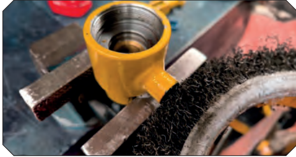
Görsel 4.85: Silindir bağlantı noktası temizlik işlemi
