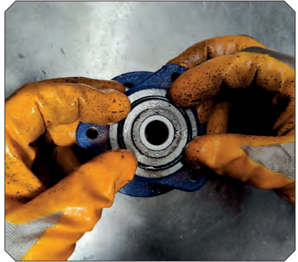
Görsel 2.168: O-ringin yerleştirilmesi
