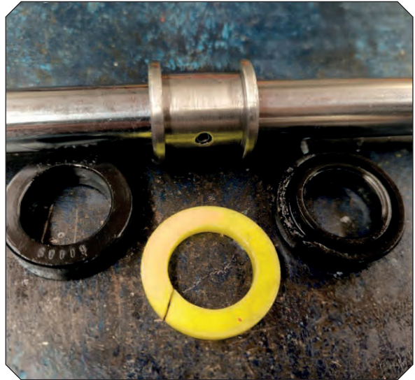
Görsel 4.78: Sızdırmazlık elemanları sökülmüş piston
