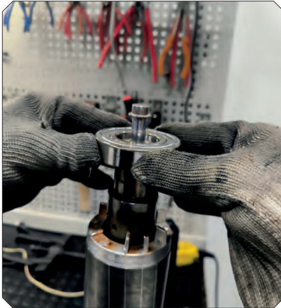
Görsel 3.70: Isıtılan rulmanın yerleştirilmesi
