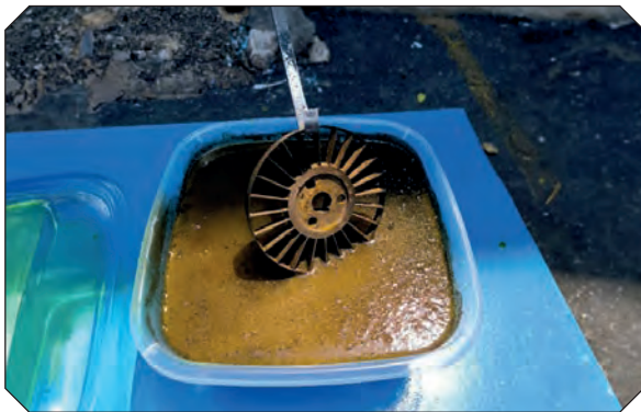
Görsel 3.35: Korozyonun yüzeyde toplanması
