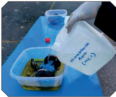
Görsel 2.115: Elemanların asite yatırılması
