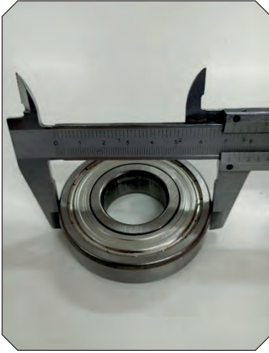
a) Dış çap ölçümü
