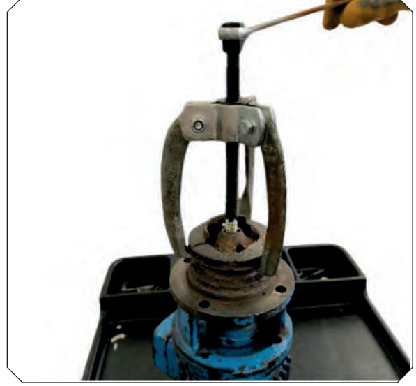
Görsel 3.25: Çektirme aparatı ile çarkın sökülmesi
