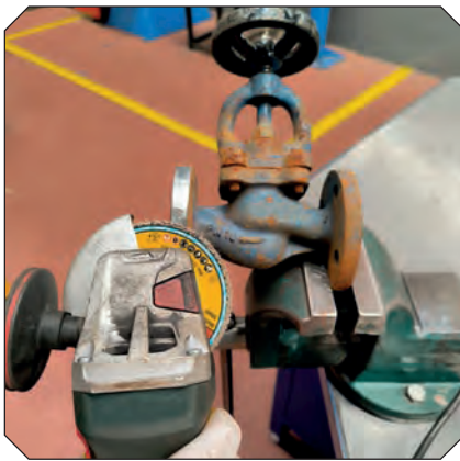
Görsel 2.101: Taşlama motoru ile temizlik
