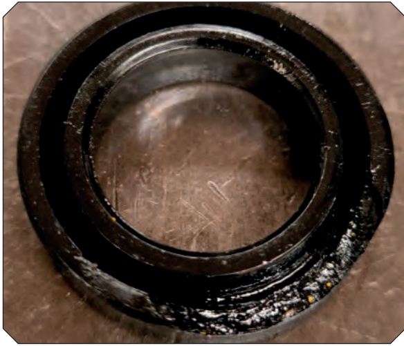
Görsel 4.75: Aşınmış-parçalanmış sızdırmazlık elemanı
