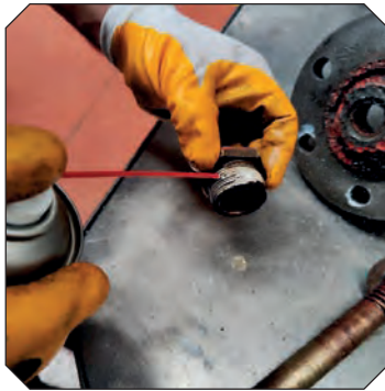
Görsel 2.132: Disk ve mil bağlantısının yağlanması
