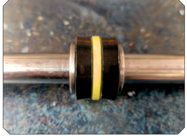
Görsel 4.80: Sızdırmazlık elemanları değiştirilmiş piston
