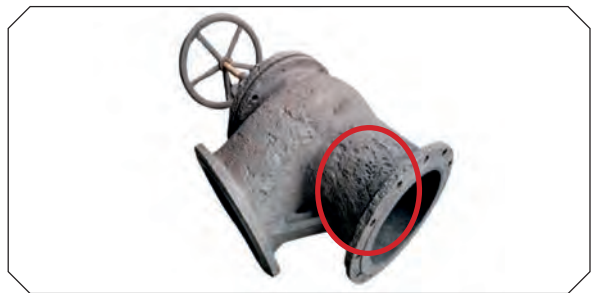
Görsel 2.83: Çukur korozyonu
