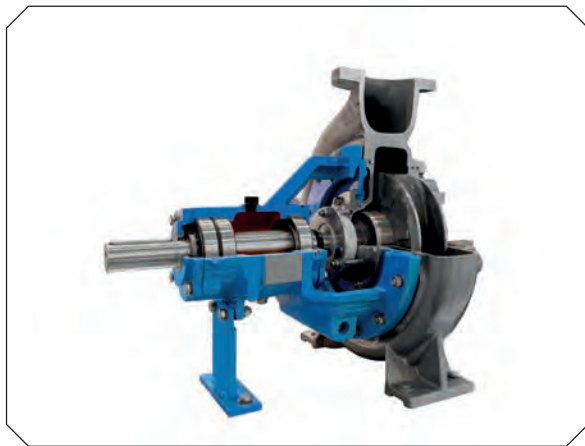
Görsel 3.49: Tek kademeli pompa kesiti
