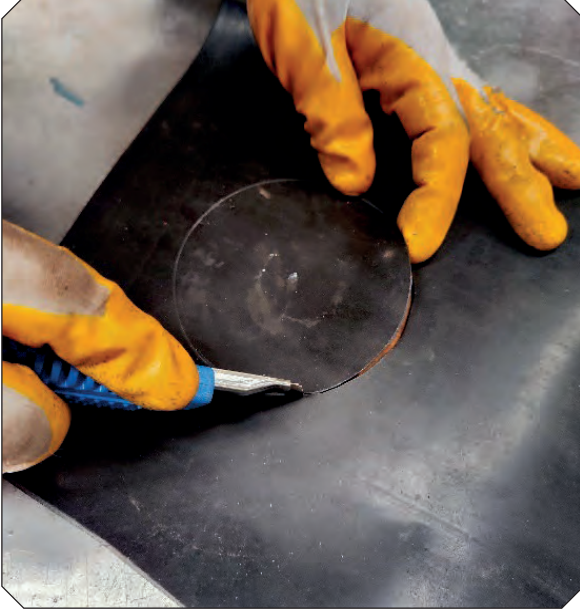
Görsel 2.158: İç çap ölçüsünün kesilmesi
