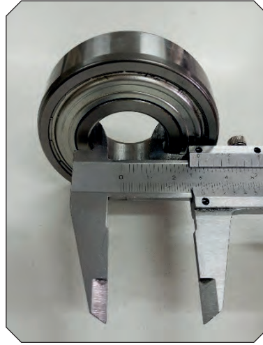
b) İç çap ölçümü
