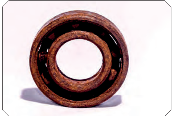
Görsel 3.61: Korozyona uğramış bir rulman
