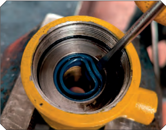
Görsel 4.81: Silindir boğazı sıyırma keçesi çıkarma işlemi
