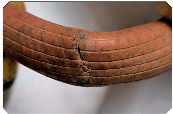
Görsel 4.116: Hasarlı hava hortumu
