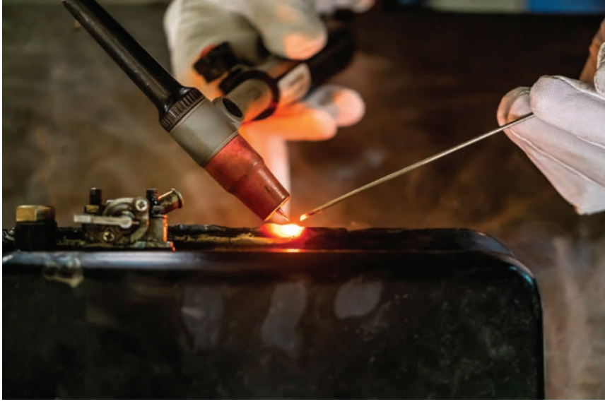
Görsel 5.7: TİG boru kaynağında elektrot tutuluşunun görünüşü
