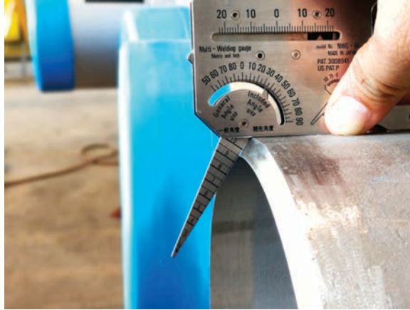
Görsel 3.5: Kaynak ağzı kontrolünün yapılması
