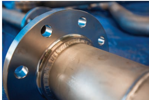
Görsel 4.3: Flanş kaynağı
