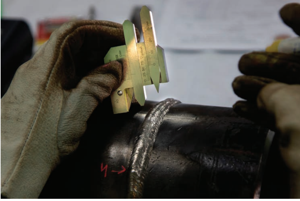
Görsel 3.9: Dikiş yüksekliği ve genişliğinin kaynak kumpasıyla ölçülmesi
