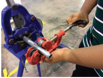
Görsel 1.2: Boru makası ile boru kesme
