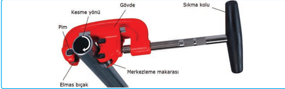
Görsel 2.10: Boru keskisi kısımları ve kesme yönü
