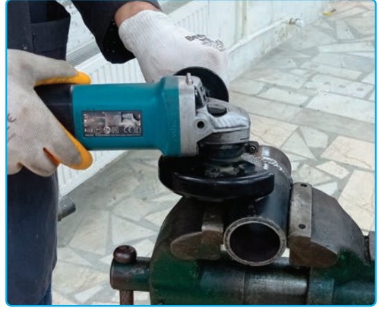
Görsel 4.7: Avuç içi taşlama makinesi ile kaynak temizliği
