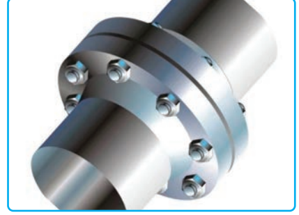
Görsel 4.12: Flanş cıvata ve somun montajı
