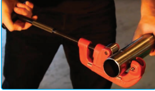
Görsel 2.14: Boru keski ile çelik boru kesme
