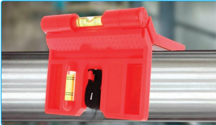
Görsel 2.23: Boru açılarının su terazisi ile kontrolü
