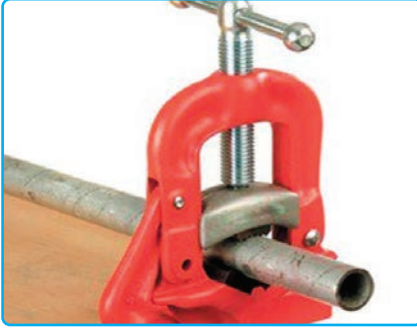
Görsel 2.13: Çelik borunun mengeneyle sabitlenmesi
