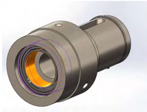
Görsel 2.20: Şaftın içine rulman yerleştirilmesi
