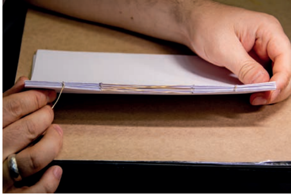
Görsel 2.89: Dikiş işlemi tamamlanmış formaların sırt görünümü
