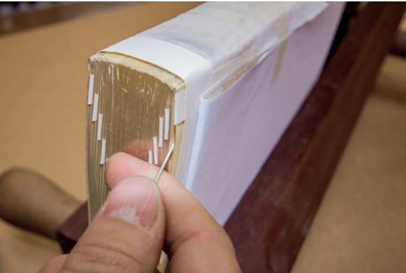
Görsel 2.116: Kolon ipini forma arasından geçirme
