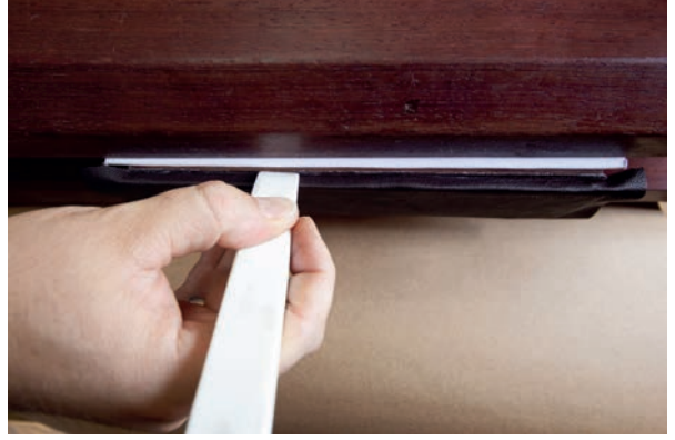
Görsel 3.180: Deri dip kısmının yapıştırılması
