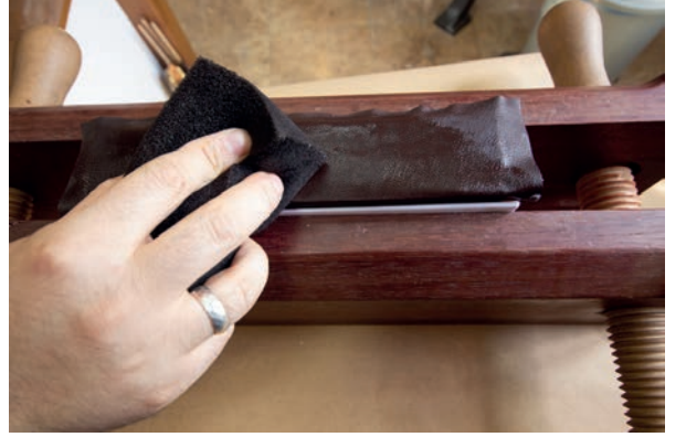
Görsel 3.177: Su ile derinin nemlendirilmesi
