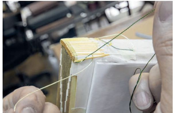
Görsel 2.159: İplerin hareketli düğümden geçirilmesi
