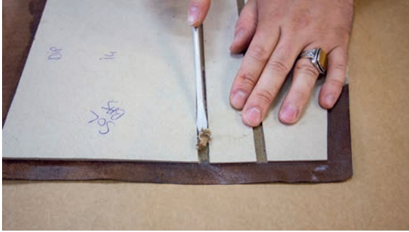
Görsel 3.64: Boşlukların tornavida ile temizlenmesi
