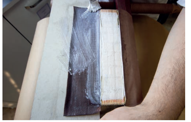
Görsel 3.158: Derinin açık olan yüzeyine tutkal sürme
