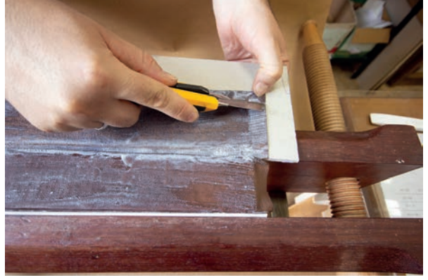
Görsel 3.171: Kitabın baş kısmında iz üzerinden fazla derinin kesilmesi
