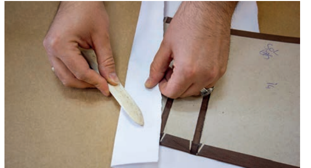
Görsel 3.89: İstekayı yapışan yüzey üzerinde gezdirme
