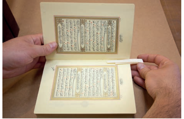
Görsel 2.110: Saplamanın ilk formanın ortasına yerleştirilmesi
