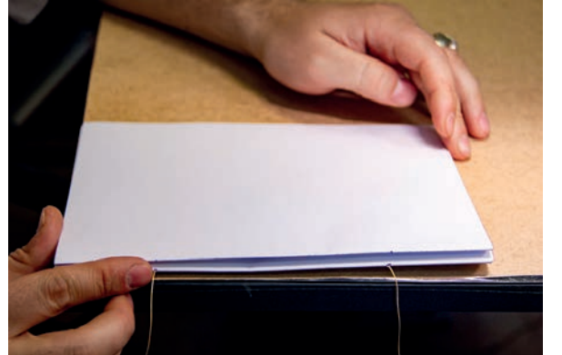
Görsel 2.49: İkinci formanın yerleştirilmesi
