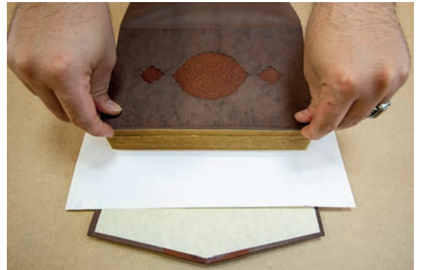
Görsel 3.139: Sağ kabı köşelerinden metin bloğuna hizalama
