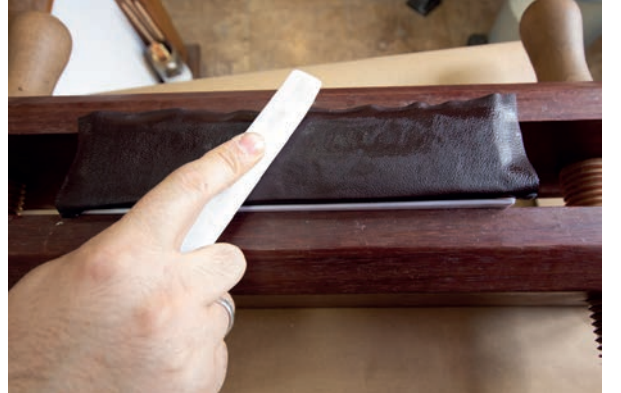
Görsel 3.178: Deriyi isteka ile sırta yapıştırma
