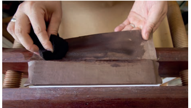
Görsel 3.164: Sağ kap sırt derisinin ıslatılması
