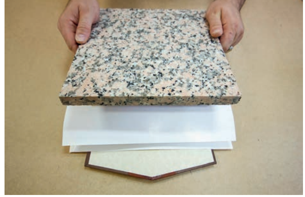
Görsel 3.136: Yapıştırılan kabın ağırlık altında bekletilmesi
