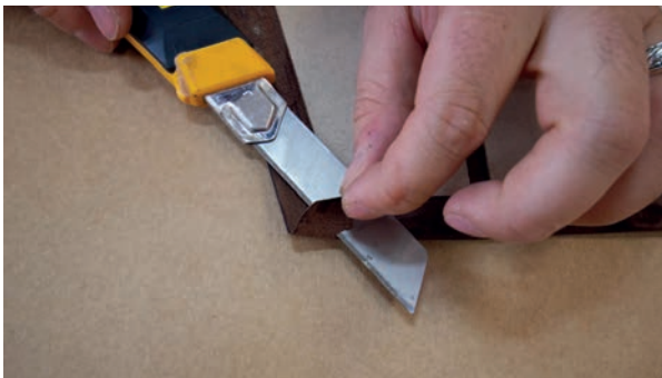
Görsel 3.74: Kıvrıma payının köşesinin kesilmesi
