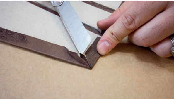
Görsel 3.92: Diğer kenarın fazla kısmının çıkarılması
