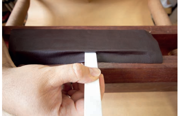
Görsel 3.168: Deri üzerinden iz yapımı
