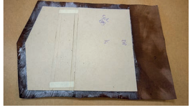
Görsel 3.44: Sol kap murakkalarının deri üzerine yapıştırılması
