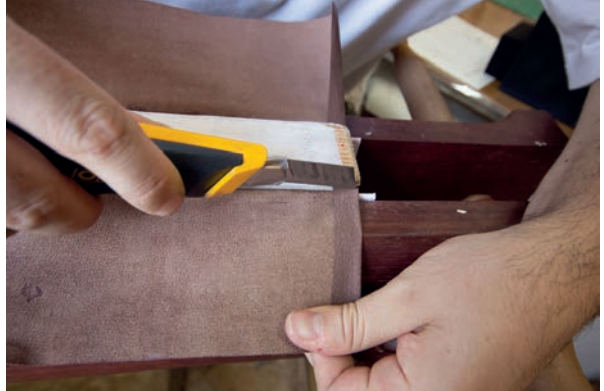
Görsel 3.144: Muhat kenarlarının katlı kısımlarının kesilmesi
