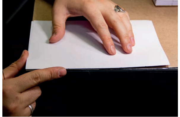
Görsel 2.65: İlk formanın yerleştirilmesi
