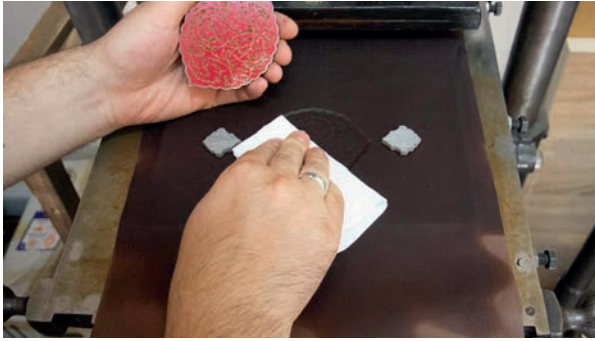
Görsel 3.53: Baskı aralarında deri üzerine çıkan suyun peçete ile alınması
