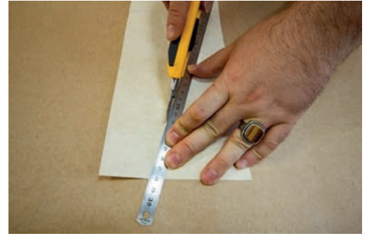
Görsel 3.126: Metal cetvel ve maket bıçağı ile kesim işlemi
