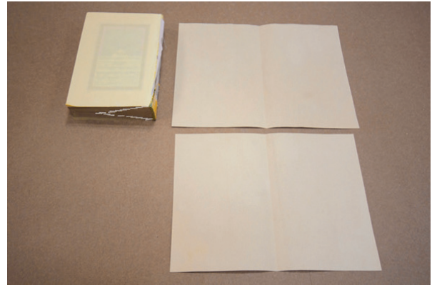
Görsel 2.173: Yan kâğıtların kat yerlerinin belirlenmesi
