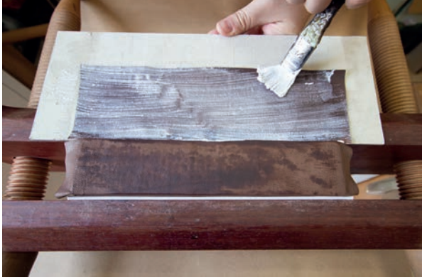
Görsel 3.165: Derinin iç yüzeyine tutkal sürme
