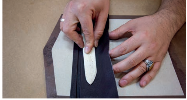
Görssel 3.105: Derinin sertab yüzeyine yapıştırılması
