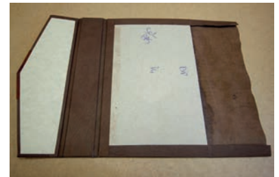
Görsel 3.130: Yapıştırma işlemi tamamlanmış mikleb yan kâğıdı
