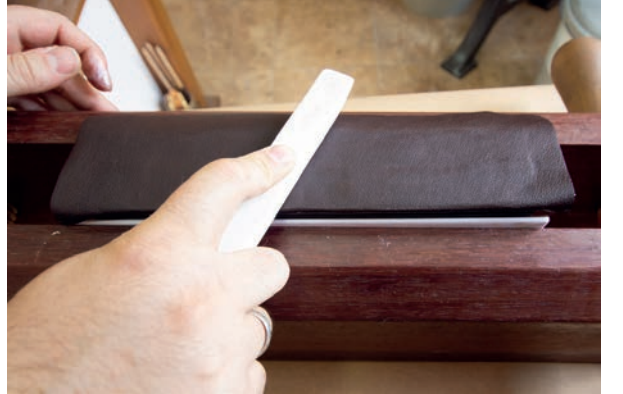
Görsel 3.167: Yapışan deriyi isteka ile düzeltme
