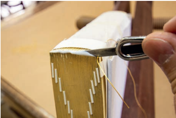
Görsel 2.128: İp için yapışkan sürme
