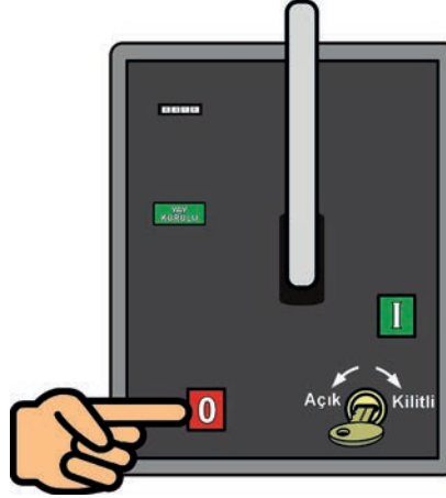
Görsel 1.63: Kesicinin açma butonuna basılarak kontaktlarının açılması
