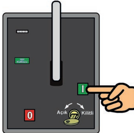
Görsel 1.61: Kesicinin kapama butonuna basılarak kontaktlarının kapatılması
