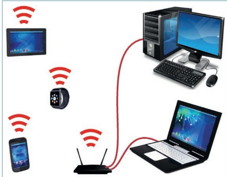
Görsel 5.18: Cihazların ağa hibrit bağlantısı
