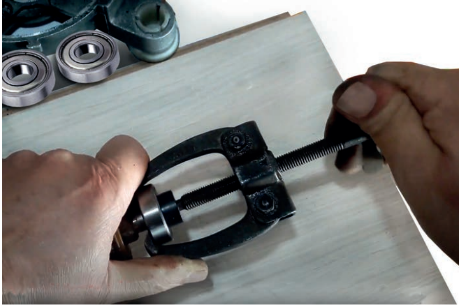
Görsel 3.20: DC motorda arızalı rulmanın değiştirilmesi
