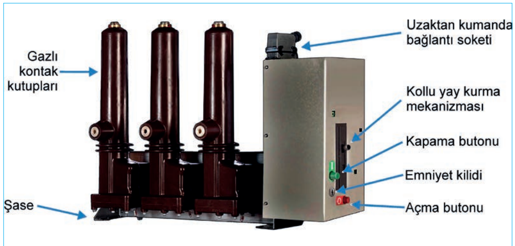
Görsel 1.13: Metal muhafazalı modüler hücrelerde kullanılan SF6 gazlı kesicinin yapısı
