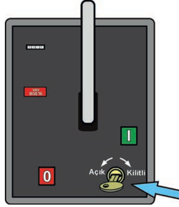
Görsel 1.59: Anahtarla kesicinin kilit mekanizmasının açılması
