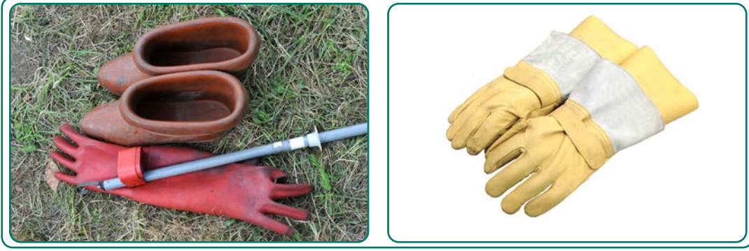
Görsel 5.1: Yüksek gerilim koruma ekipmanları
