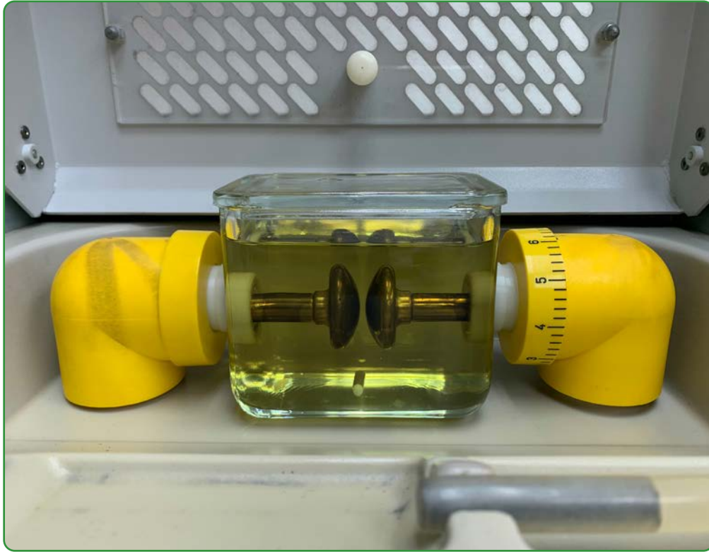
Görsel 2.10: Transformator yağ testi
