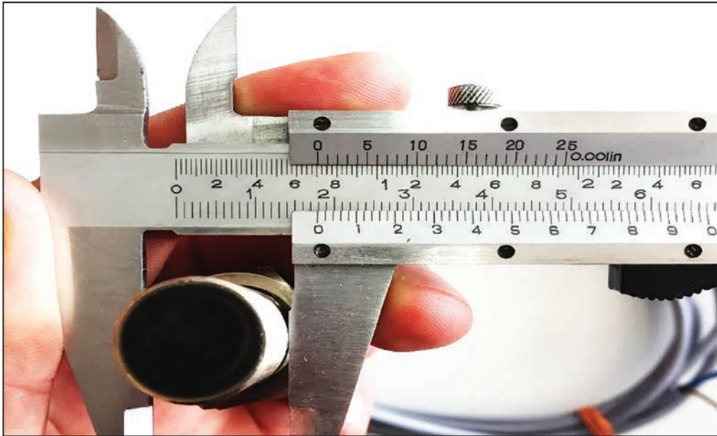
Görsel 1.9: Kumpas ile sensör çapı ölçümü
