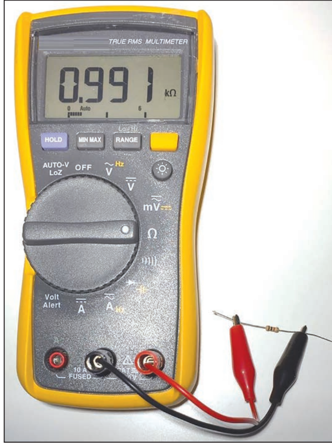
Görsel 4.11: Multimetre ile direnç ölçme işlemi
