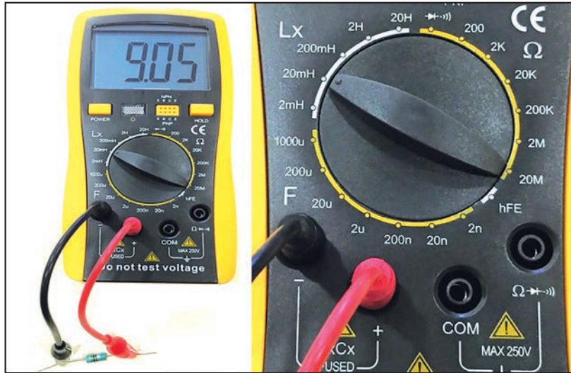
Görsel 4.23: LCRmetre ile endüktans ölçümü
