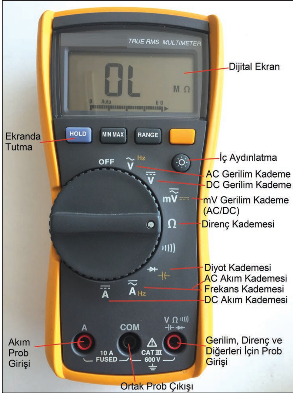
Görsel 1.34: Multimetrenin yapısı
