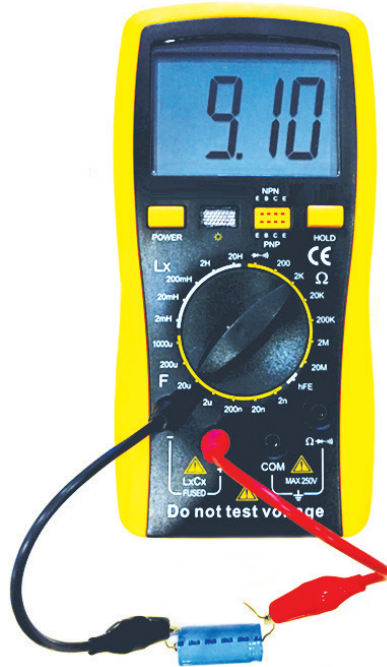
Görsel 4.20: LCRmetre ile kapasite ölçümü
