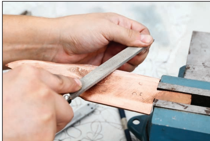
Görsel 3.12: Mengene üzerindeki parçanın eğelenmesi işlemi
