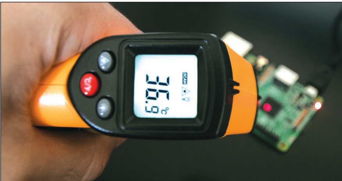
Görsel 1.18: Kızılötesi termometre ile devrede sıcaklık ölçümü
