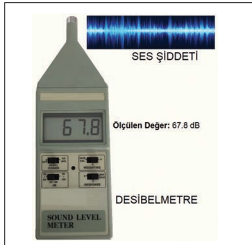
Görsel 1.16: Desibelmetre ile ses şiddetinin ölçülmesi
