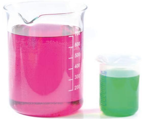
Görsel 1.6: Titrasyon sıvısı damlatılmadan önce ve sonra test suyu rengi
