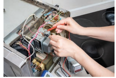
Görsel 6.6: Arızalı mikrodalga makinesinin tamiri
