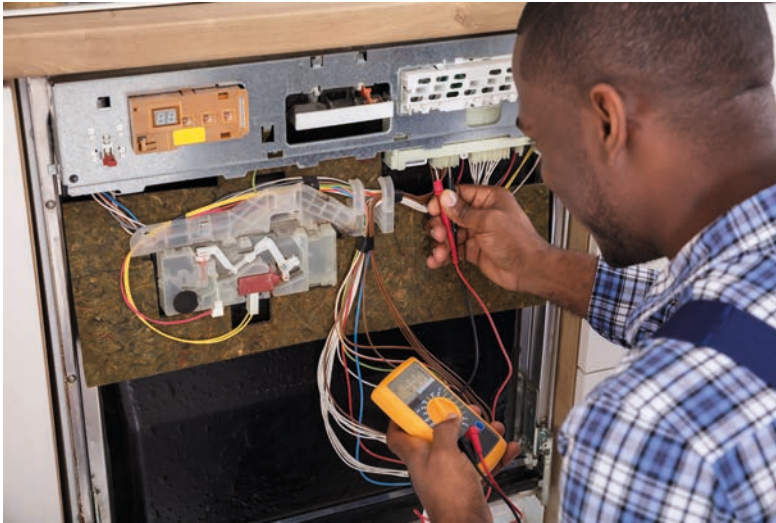
GörSEL 5.6: Bulaşık makinesi deterjan ve parlaticı haznesi arka kısmı
