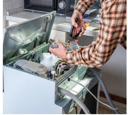
Görsel 5.22: Bulaşık makinesinin ısıtıcı rezistansı ve rezistansının değişimi
