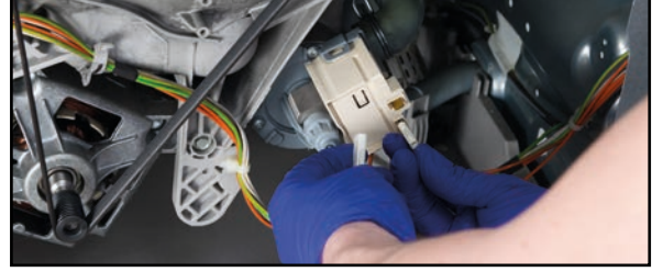
Görsel 4.28: Arızalı NTC sensörü
