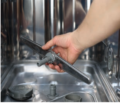
Görsel 5.30: Bulaşık makinesinin alt ve üst pervanesinin temizliği
