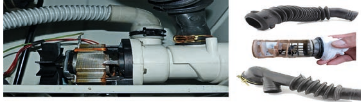
Görsel 3.55: Su tahliye pompası ve su giriş çıkış hortumları
