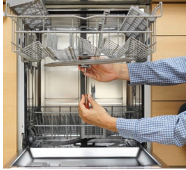
Görsel 5.30: Bulaşık makinesinin alt ve üst pervanesinin temizliği
