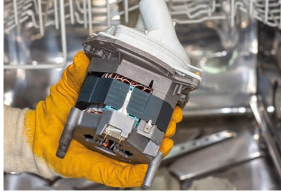
Görsel 5.23: Bulaşık makinesinin yıkama (sirkülasyon) pompası ve pompasının değişimi
