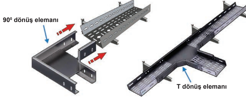
Görsel 2.17: Metal kablo kanalı dönüş aksesuarlarının montajı
