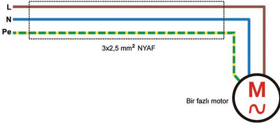
Görsel 1.28: Bir fazlı motorun topraklama bağlantısı
