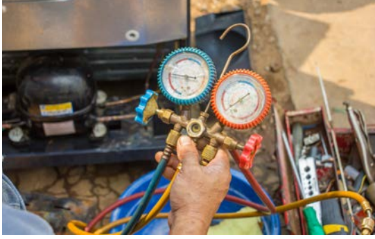
Görsel 2.24: Manifold ile ölçüm yapma işlemi
