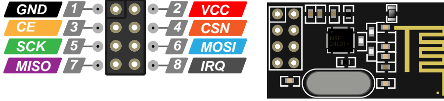
Görsel 3.79: nRF24L01+ pin yapısı
