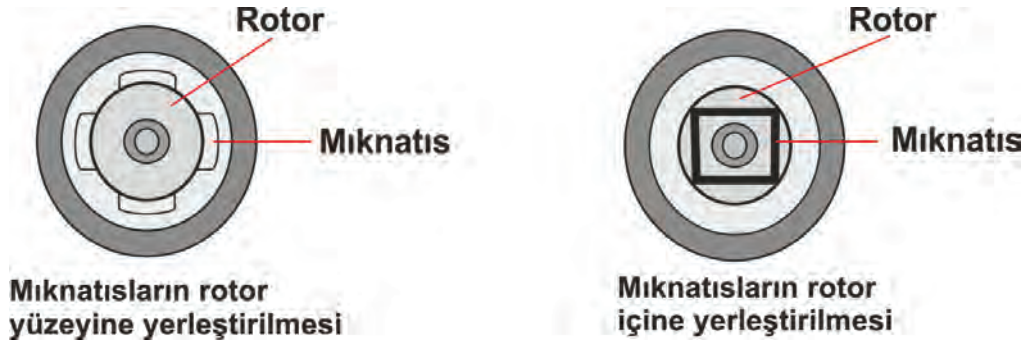
Görsel 4.3: SMSM motorlarda mıknatısların rotora yerleştirilmesi
