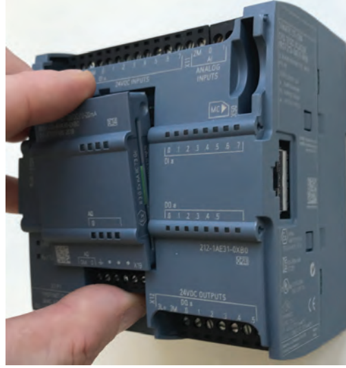
Görsel 7.13: PLC analog sinyal board montajı
