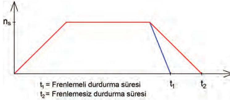
Görsel 3.1: Motorun frenlemeli ve frenlemesiz durma süreleri
