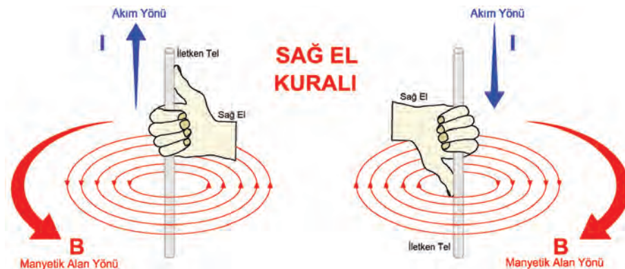
Görsel 1.7: Sağ el kuralına göre akım ve manyetik alan yönünün tespiti
