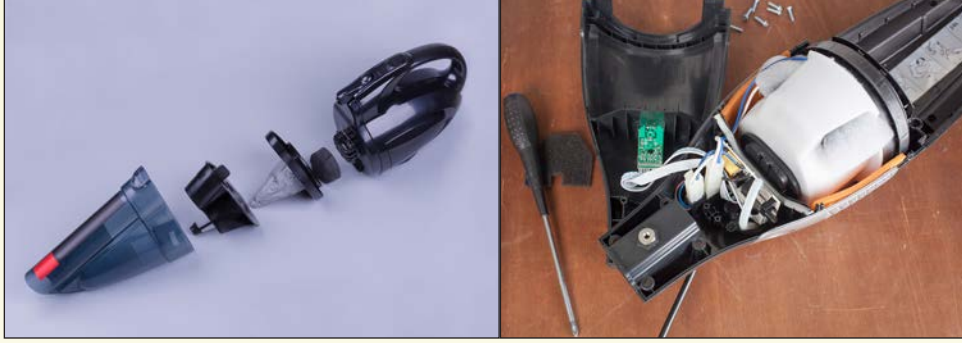
Görsel 7.2: Şarjlı elektrik süpürgesinin iç yapısı
