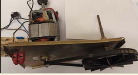
Görsel 2.29: Mutfak robotunun iç yapısı
