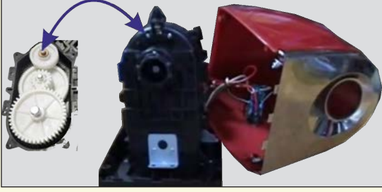
Görsel 2.49: Kıyma makinesinin iç yapısı
