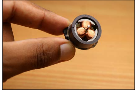
Görsel 9.16: Doğal mıknatıslı endüktör ve endüvi
