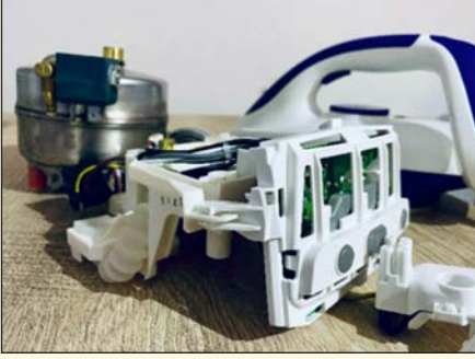
Görsel 6.25: Buhar kazanlı ütünün kazan kısmı
