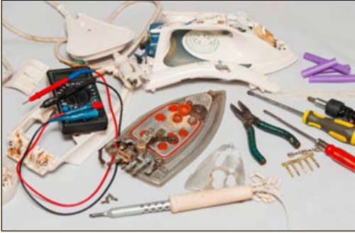
Görsel 6.12: Buharlı ütünün iç yapısı
