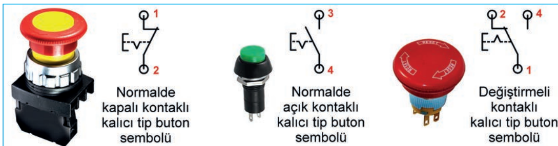
Görsel 2.7: Kalıcı tip butonlar ve elektropnömatik devre sembolleri
