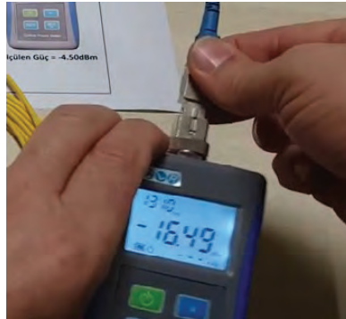
Görsel 4.109: Optik güçölçer cihazına sabit zayıflatıcı takılması
