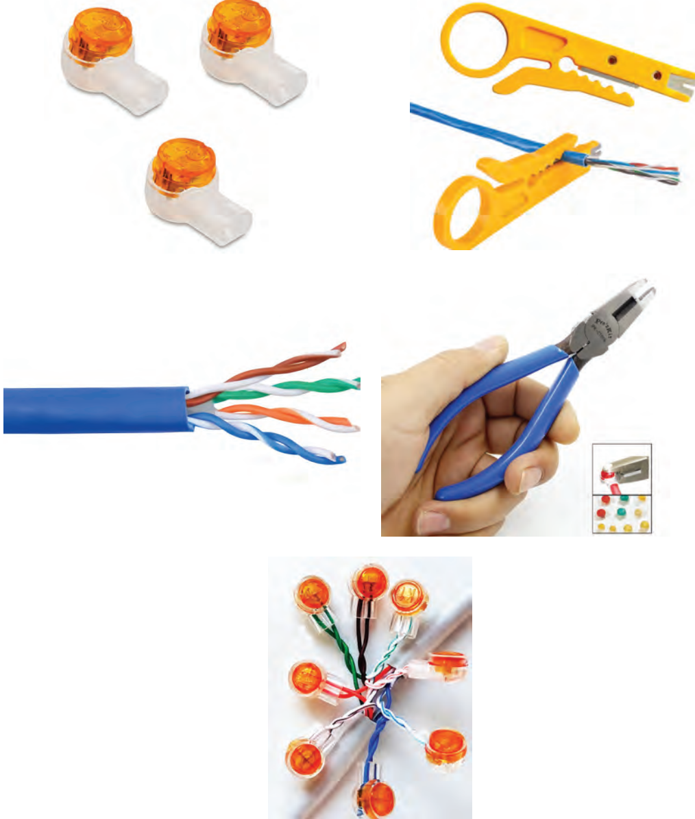
Görsel 5.25: Telefon kablosuna yak kullanılarak ek yapılması
