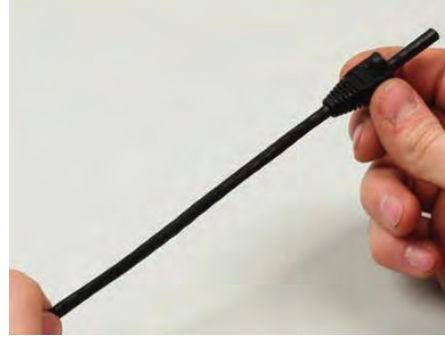
Görsele 4.32: CAT kabloya RJ45 kapağının takılması
