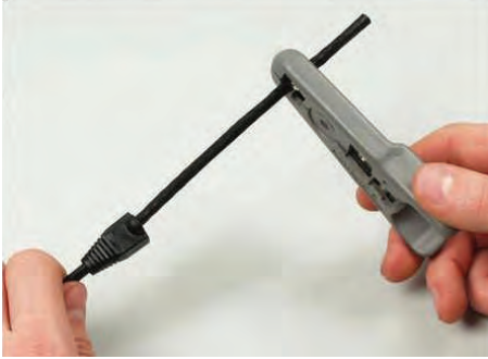
Görsele 4.33: CAT kablonun PVC kılıfının kesilmesi
