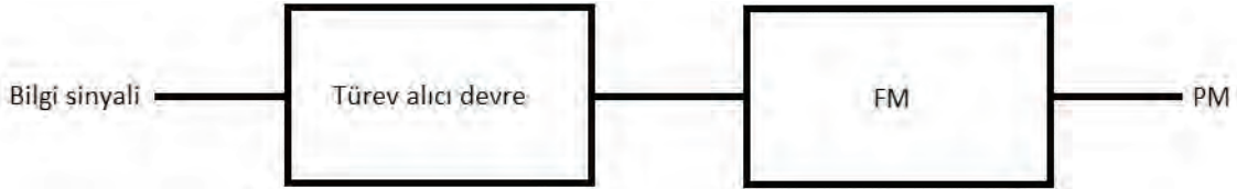
Görsel 2.10: Faz modülesi sinyalin elde edilmesi
