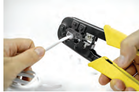
Görsele 4.38: RJ45 konnektörün penseyle sıkılması
