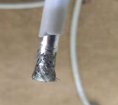
Görsel 4.47: Dış kılıfı çıkarılmış koaksiyel kablo
