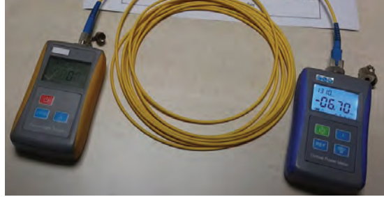
Görsel 4.108: Optik güçölçer cihazıyla fiber optik kabloda zayıflama ölçümü
