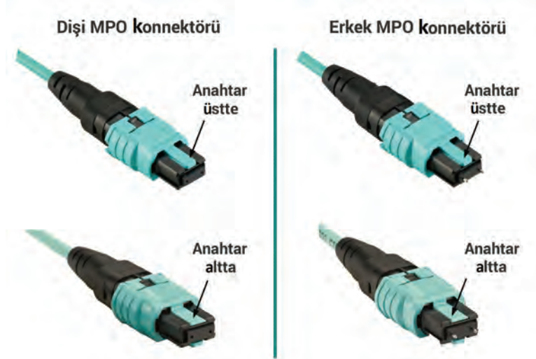
Görsel 4.95: Dişi ve erkek MPO / MPT tip fiber konnektörler
