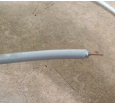
Görsel 4.49: Folyo koruması çıkarılmış koaksiyel kablo
