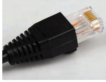
Görsel 4.39: Plastik kapağın RJ45 konnektöre takılması
