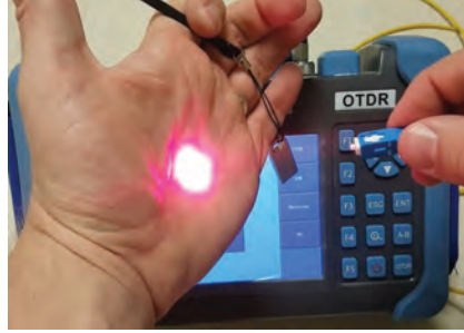
Görsel 4.107: OTDR cihazıyla fiber optik kablo testi
