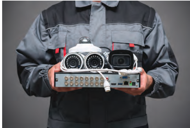
Görsel 4.53: CCTV kamera ve BNC bağlantılı DVR cihazı
