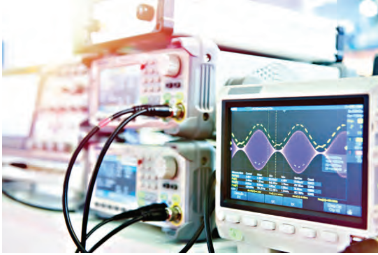
Görsel 2.5: Genlik modüleli sinyal ile bilgi sinyalinin karşılaştırılması
