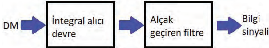
Görsel 3.52: DM demodülasyonunun çizimi
