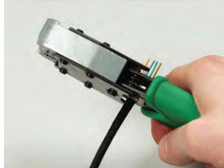
Görsele 4.36: CAT kablodaki tellerin kesilmesi
