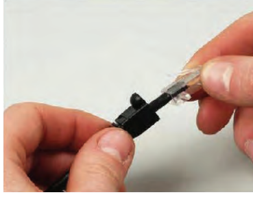
Görsel 4.39: Plastik kapağın RJ45 konnektöre takılması
