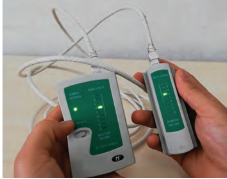
Görsel 4.64: Ağ kablo test cihazıyla CAT kablo testi
