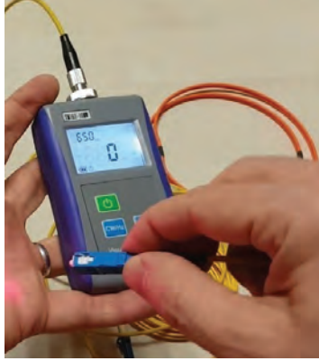
Görsel 4.106: Fiber optik ışık test cihazıyla fiber optik kablo testi
