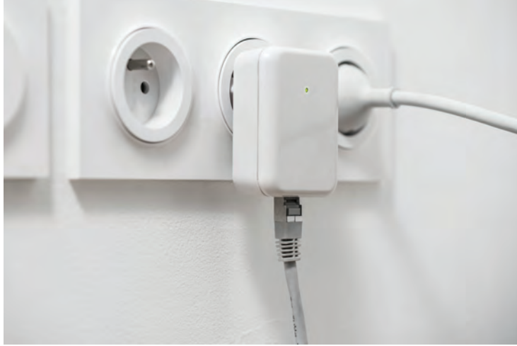
Görsel 4.9: Duvar prizine takılı elektrik hattı ağ bağdaştırıcısı
