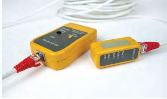
Görsel 4.40: CAT kabloyu test etme
