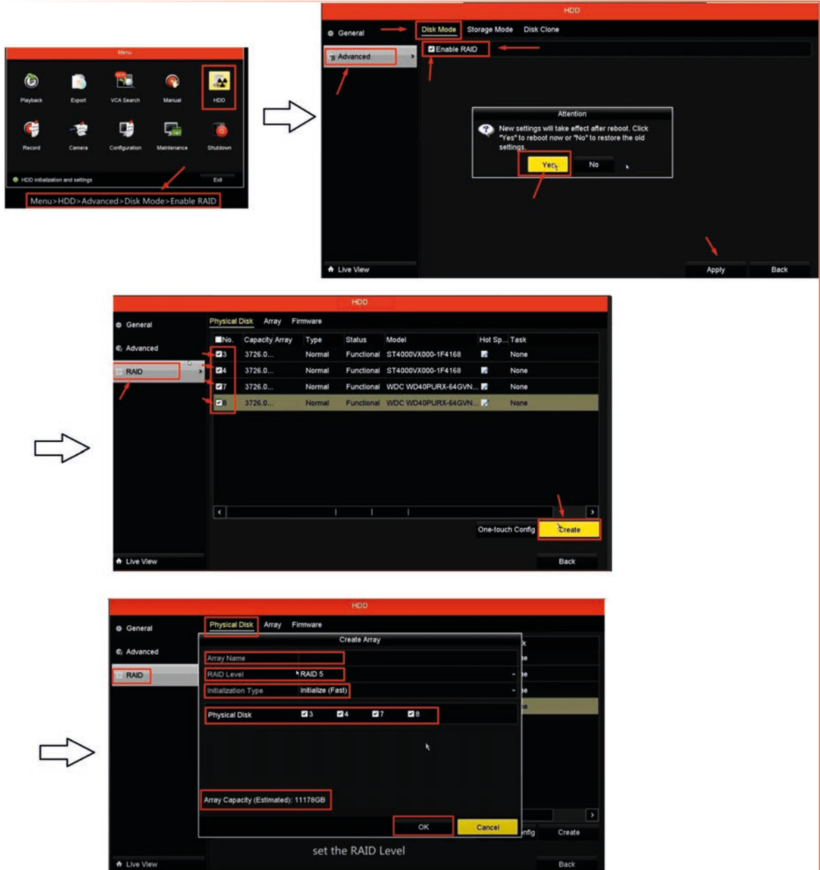
Görsel 3.46: NVR cihazına RAID işlemi adımları
