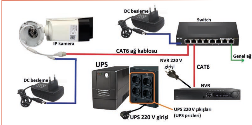
Görsel 3.53: CCTV sistemine UPS bağlantısı
