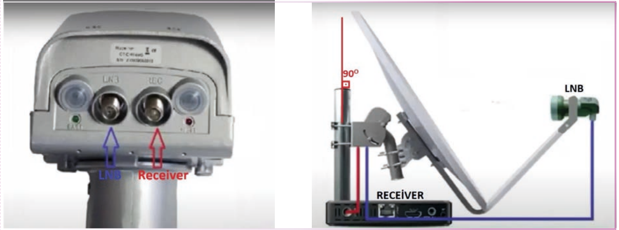
Görsel 2.49: Diseqc motorun uydu alıcısıyla bağlantısı
