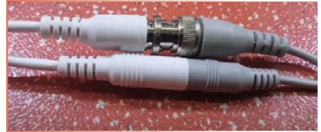
Görsel 3.7: BNC konnektör ve besleme jak bağlantısı
