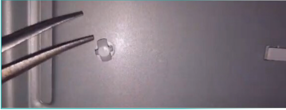
Görsel 1.84: LED barların arkasındaki plastik parçacıkların sökülerek reflektörün çıkarılması
