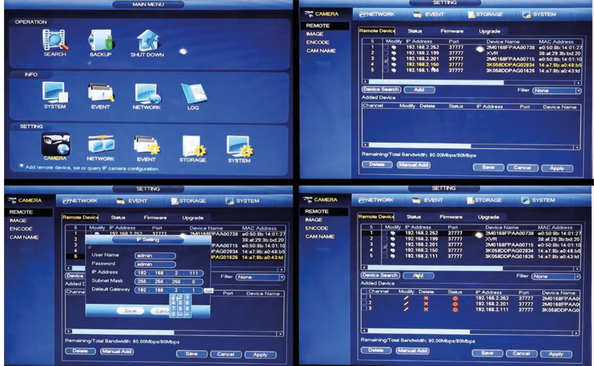
Görsel 3.44: NVR cihazına IP kamerayı ekleme ve ayarlama adımları
