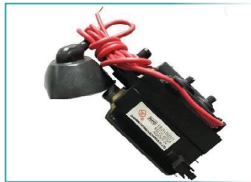
Görsel 1.42: EHT transformatörü
