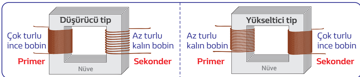
Görsel 3.111: Düşürücü ve yükseltici tip transformatörler
