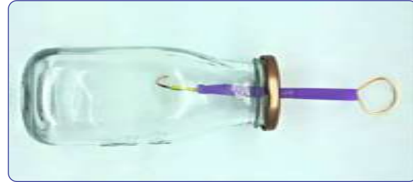
Görsel 1.89: Yaprakları olmayan bir elektroskop
