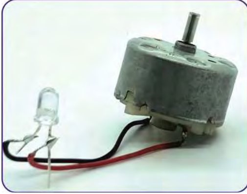
Görsel 1.20: Motor uçlarına LED'in lehimlenmesi
