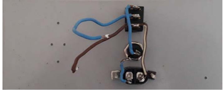
Görsel 3.47: Güç soketi, sigorta yuvası ve açma kapama kablo bağlantısı
