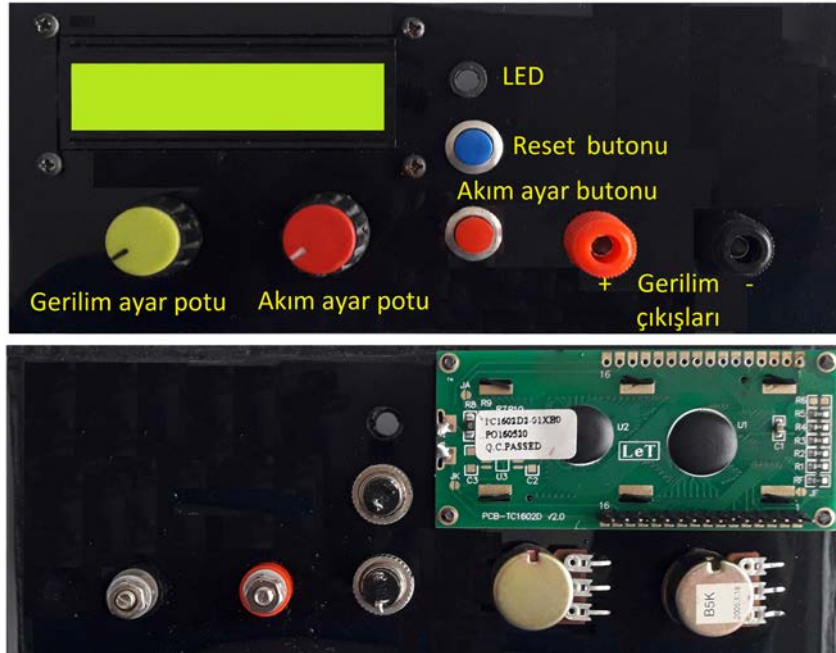
Görsel 3.39: Ön panele devre elemanlarının montajı
