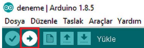
Görsel 3.66: Program kodlarının ARDUINO karta yüklenmesi
