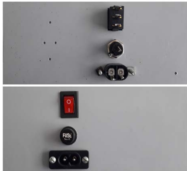
Görsel 3.32: Güç soketi, sigorta yuvası ve açma kapama anahtarı montajı
