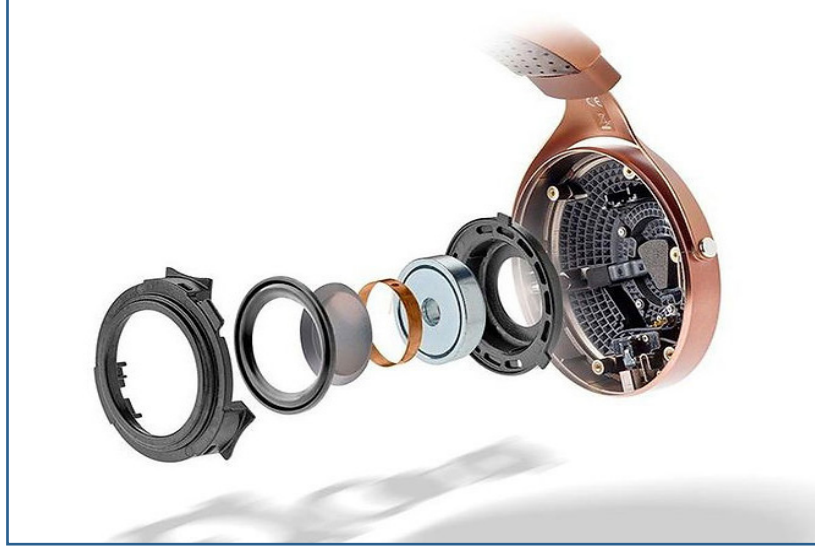
Görsel 5.5: Dinamik, kulak üstü kulaklığın yapısı
