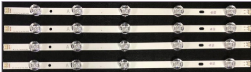
Görsel 6.30: Mercekli arka aydınlatma LED'leri (D-LED)
