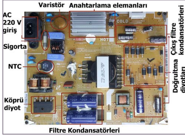
GörSEL 6.47: SMPS besleme kartında bulunan elemanlar
