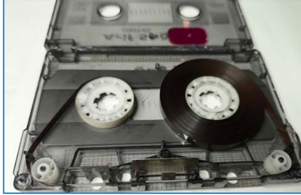
Görsel 1.5: Manyetik kaset yapısı
