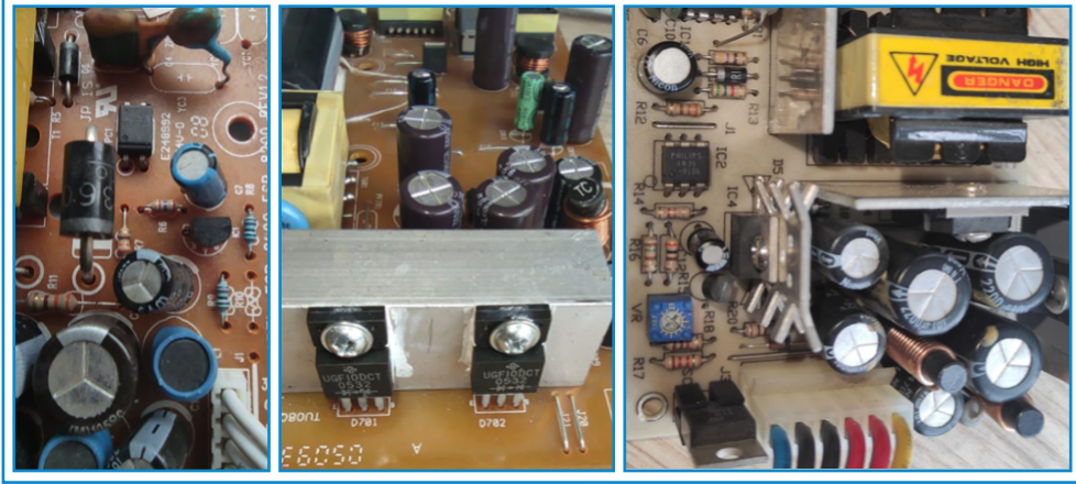
Görsel 1.44: SMPS güç kaynağı geri besleme ve çıkış elemanları
