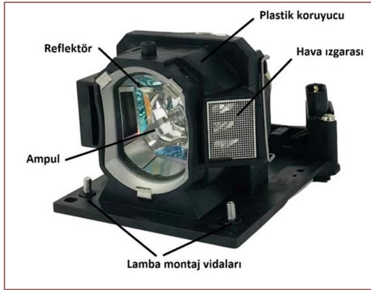
Görsel 3.12: Projektör lambasının yapısı
