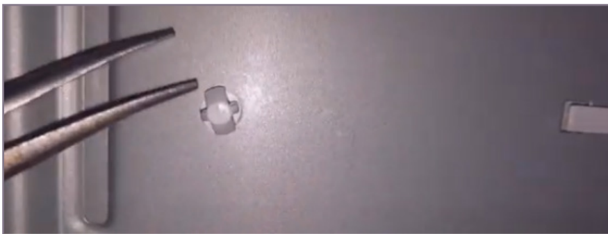
Görsel 6.42: LED barların arkasındaki plastik parçacıkların sökülerek reflektörün çıkarılması
