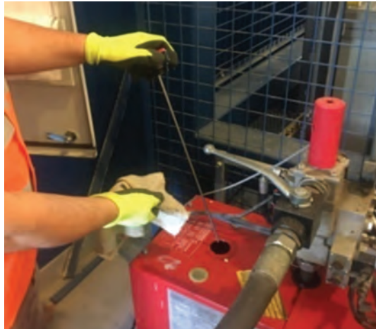
Görsel 2.21: Yağ seviyesinin kontrolü
