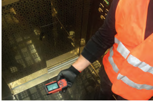
Görsel 3.12: Lüksmetreyle aydınlatma şiddetinin kontrolü
