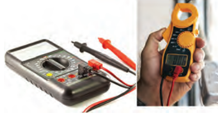
Görsel 1.10: Multimetre ve pens ampermetrenin kullanımı
