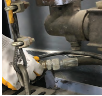
Görsel 3.19: Boru kırılma valfinin kontrolü
