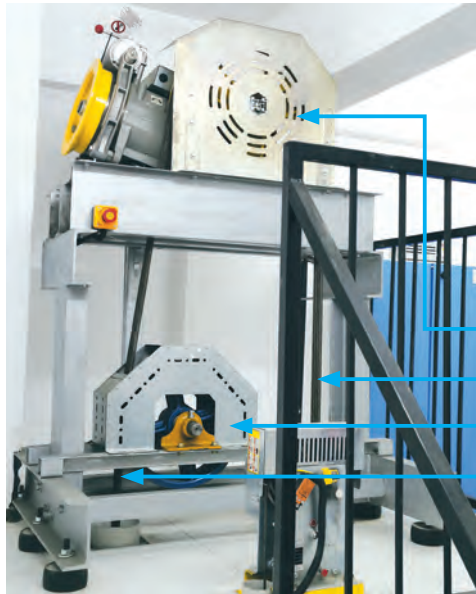
Görsel 7.11: Makine-motor tahrik ve saptırma kasnağı
