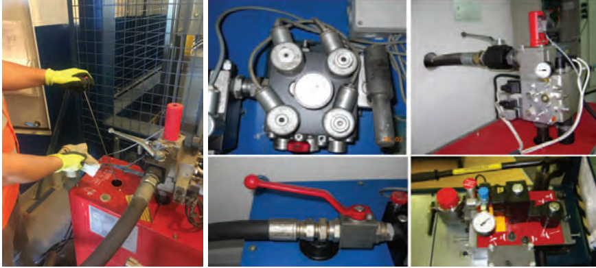
Görsel 12.31: Tanka yağ dolumu, göstergenin ve valflerin kontrolü
