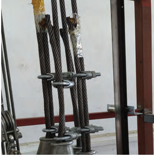
Görsel 9.15: Halat bağlantı klemensi, bağlantı şekli ve halat klemensi
