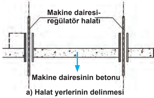
Görsel 9.17: Hız regülatörü resmi, halat yerlerinin delinmesi, örnek alt plaka resmi
