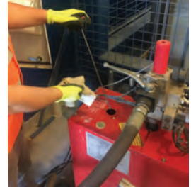
Görsel 12.30: Yağ seviyesi kontrolü
