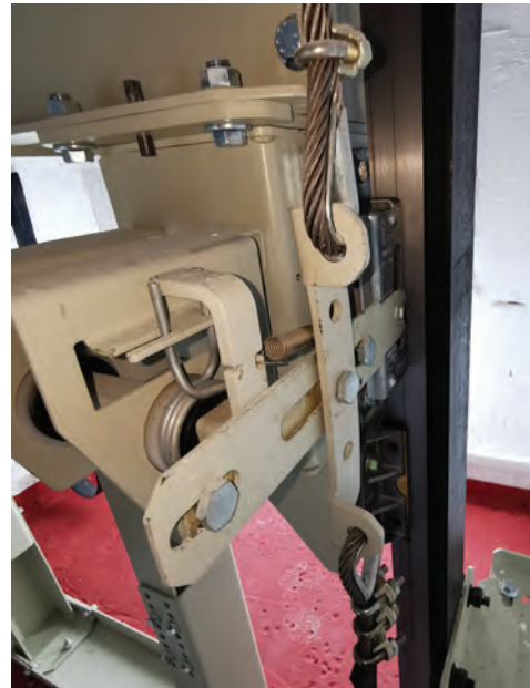
Görsel 8.12: Regülatör halatının fren koluna bağlantısı
