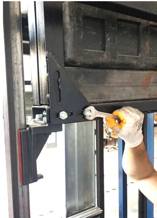
Görsel 8.19: Yan direklerin montajı
