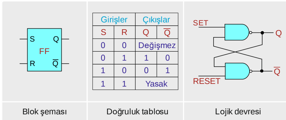
Görsel 6.47: NAND kapılı RS flip-flop
