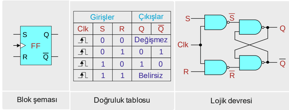
Görsel 6.48: Tetiklemeli RS flip-flop
