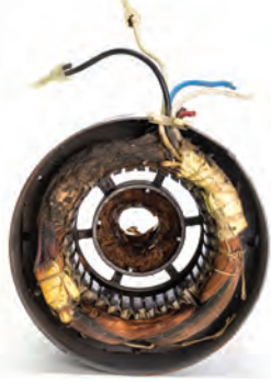
Görsel 5.11: Yanmış stator sargıları
