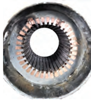
b) Bir tarafında bulunan stator sargıları kesilmiş asenkron motor
