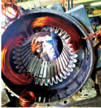
a) 1. kat sargılarının statora yerleştirilmesi
