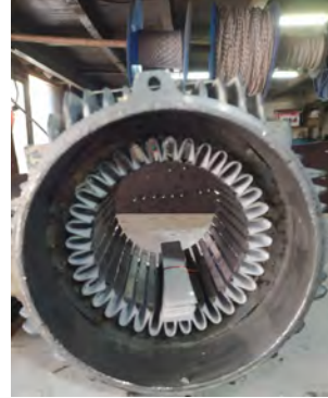
b) Temizlenmiş ve olukları presbantla yalıtılmış stator
