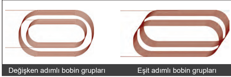
Görsel 7.2: Eşit adımlı ve değişken adımlı bobin grupları
