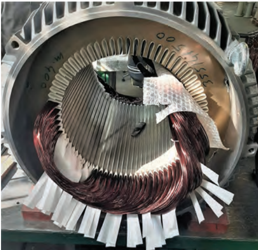
Görsel 9.29: Tam kalıp sarım tekniğine göre sargıların statora yerleştirilmesi
