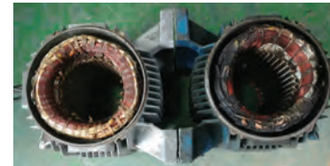
Görsel 5.9: Aşırı akım sonucu yanan stator
