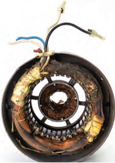
Görsel 5.2: Yanmış stator
