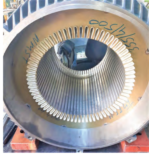
Görsel 9.28: Stator oluklarının presbant ile yalıtılması
