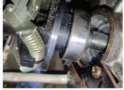
Görsel 5.20: Merkezkaç anahtarının rotor üzerindeki hareketli parçaları
