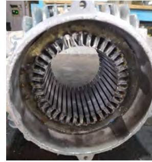
Görsel 7.3: Asenkron motor sargılarının sökülmesinde izlenecek işlem basamakları
