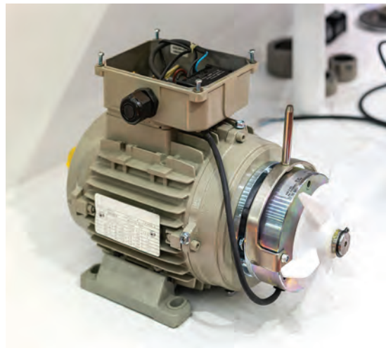
Görsel 4.5: Elle ayırma kolu bulunan fren bağlı motor
