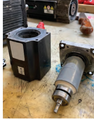
Görsel 14.5: Rotorun çıkarılması
