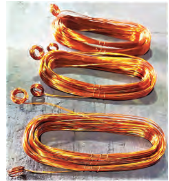
c) Gerekli sayıda sargının oluşturulması
