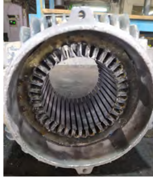
a) Sargıları sökülmiş stator
