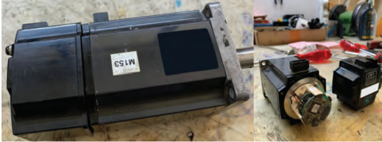
Görsel 14.2 Servo motorun enkoder kapağının sökülmesi
