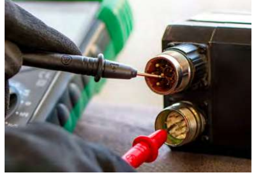
Görsel 14.9: Servo motorun güç ve sinyal soketleri
