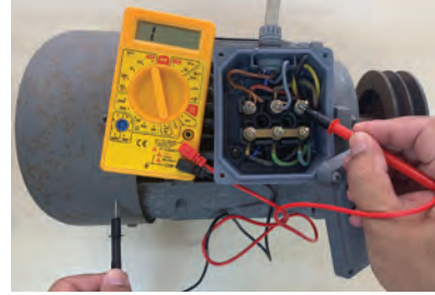
Görsel 5.4: Gövdeye kaçak kontrolü
