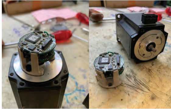
Görsel 14.3 Enkoderin sökülmesi
