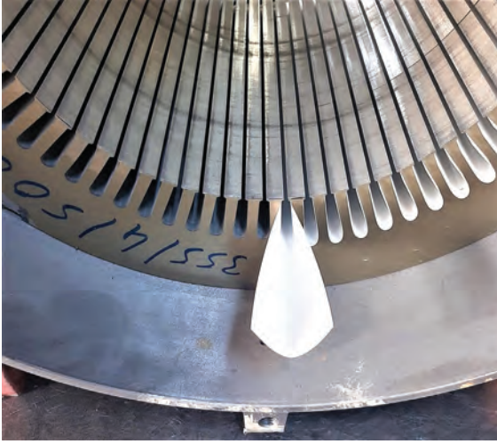
Görsel 9.28: Stator oluklarının presbant ile yalıtılması
