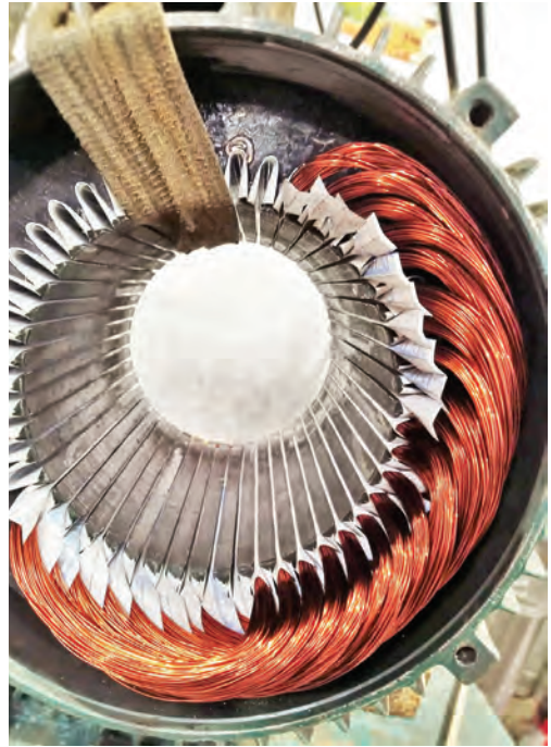
a) Yarım kalıp sarımın statora yerleştirilmesi
