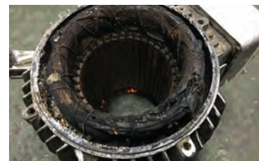
Görsel 5.9: Aşırı akım sonucu yanan stator
