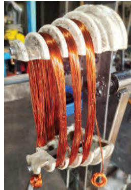
b) Kalıpların alınan ölçüye uygun olarak ayarlanması
