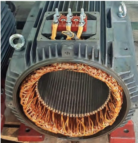
a) Sargı uçlarının klemens kutusuna çıkarılması
