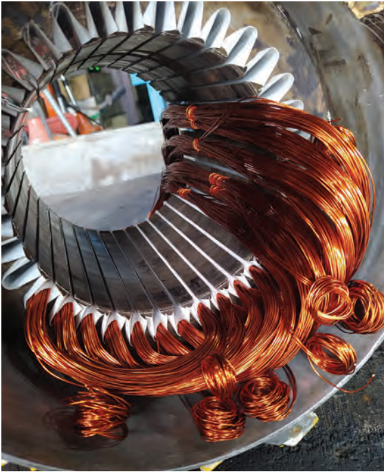
a) Yarım kalıp sarımın statora yerleştirilmesi
