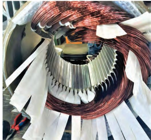
Görsel 9.29: Tam kalıp sarım tekniğine göre sargıların statora yerleştirilmesi
