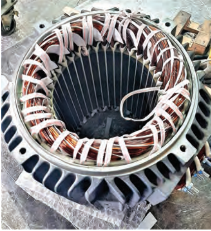
Görsel 9.30: Tam kalıp sarımda sargılara şekil verilerek bandaj ipleriyle sabitlenmesi
