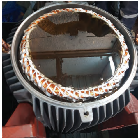
b) Stator sargılarının verniklenmesi
