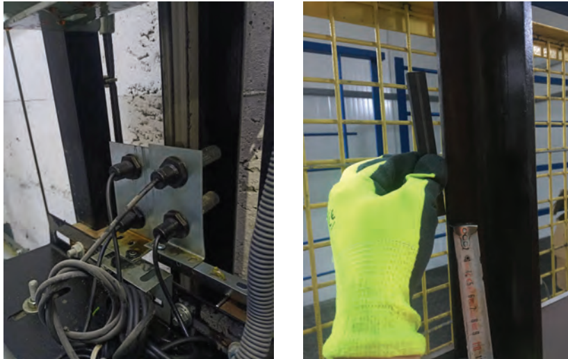
Görsel 2.26: Manyetik şalterin kontrolü ve mıknatıs ayarı
