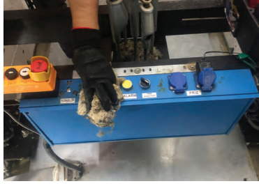
Görsel 2.38: Kabin üstünün bakımı ve onarımı
