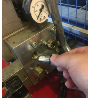
Görsel 2.8: Hidrolik filtrelerin kontrolü
