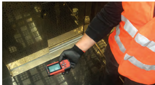
Görsel 2.51: Kabin aydınlatmasının kontrolü
