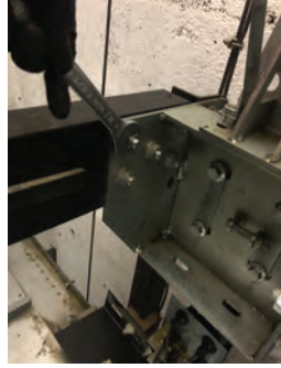
Görsel 2.32: Süspansiyonun bağlantı kontrolü
