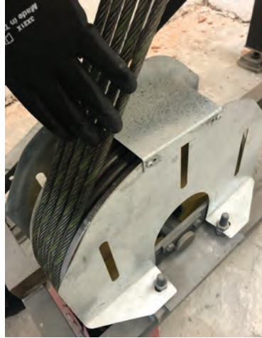
Görsel 2.3: Kasnakların çalışmasının kontrolleri
