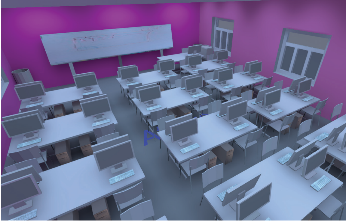
Görsel 3.35: Bilgisayar laboratuvarı aydınlatma simülasyonu sonuçları (2)
