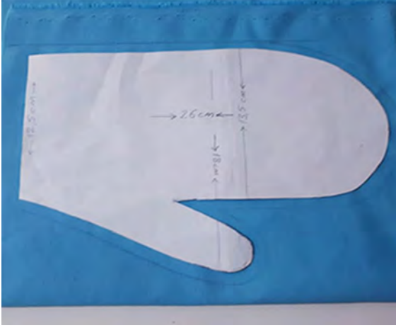
Görsel 8.19: Kalıp yerleştirme
