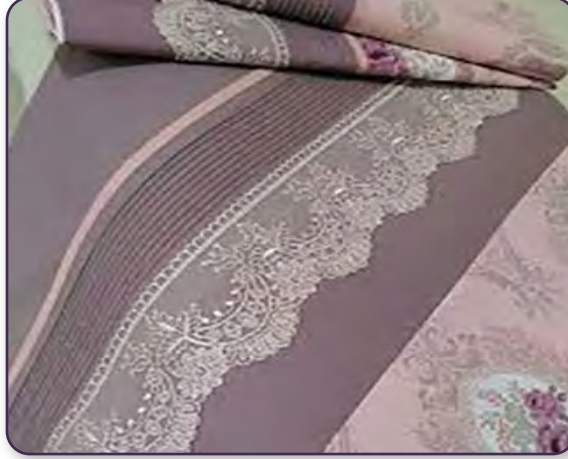
Görsel 1.2: Makinede aparatla nervür süslemesi yapılmış pike
