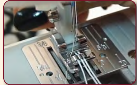
Görsel 4.26: Aparatın makineye takılması
