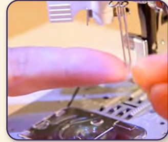
Görsel 1.8: Makineye nervür aparatı takma
