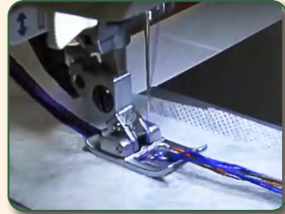
Görsel 3.27: Suda eriyen telaya makinede kordon tutturma
