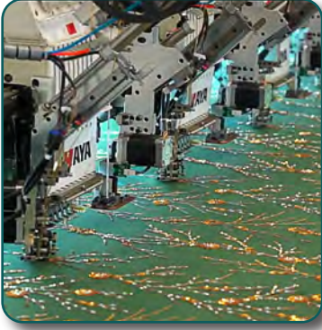
Görsel 5.1: Sanayi tipi boncuk işleme makinesi
