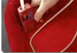
Görsel 2.122: Kordon yapıştırma işlemi
