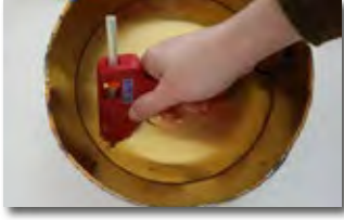
Görsel 2.237: Keçe yapıştırma işlemi
