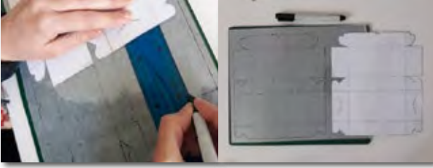
Görsel 3.89: Hazır kalıbın ölçülendirmesi ve asetata uygulanması
