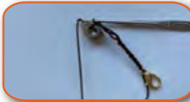
Görsel 2.45: Aparatı zincir içerisine sıkıştırma
