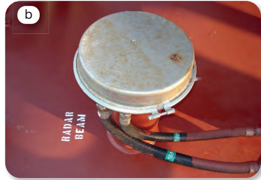
Görsel 3.94: Aleç noktası ve iskandil borusu (a), tank radar ölçüm noktası (b)
