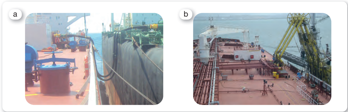
Görsel 3.93: Kargo hortumları ( cargo hoses ) (a) ve kargo kolları ( cargo arms ) (b)
