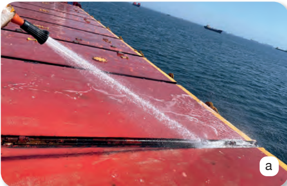
Görsel 3.2: Hortum testi (a) ve ultrasonik test (b)
