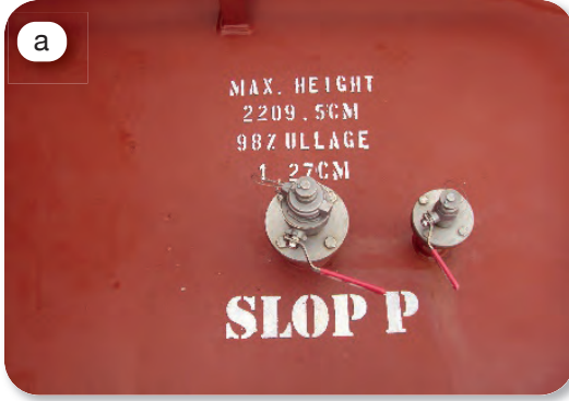
Görsel 3.94: Aleç noktası ve iskandil borusu (a), tank radar ölçüm noktası (b)
