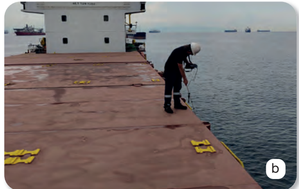
Görsel 3.2: Hortum testi (a) ve ultrasonik test (b)
