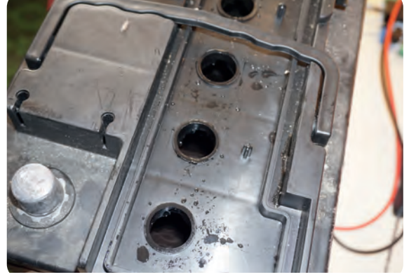
Görsel 18.11: Sıvı kontrolü yapılan bir akü
