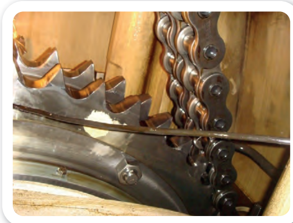
Görsel 14.3: Zincirli tip zaman ayar mekanizması ve ayar işareti
