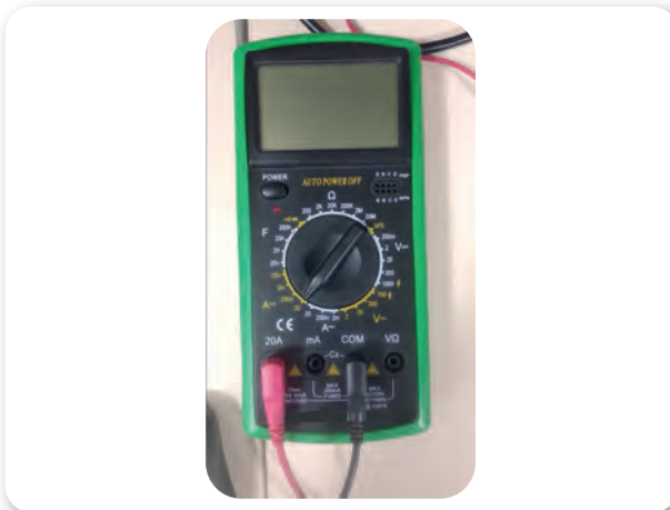
Görsel 16.6: 20 ampere kadar ölçüm yapabilmek amacıyla ayarlanmış bir avometre
