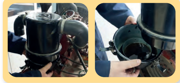
Görsel 13.5: Yağlı filtrenin bakımının yapılması
