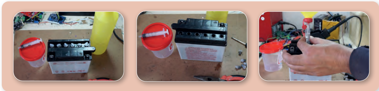
Görsel 18.18: Akü elektrolit seviyesinin kontrolü ve tamamlanması
