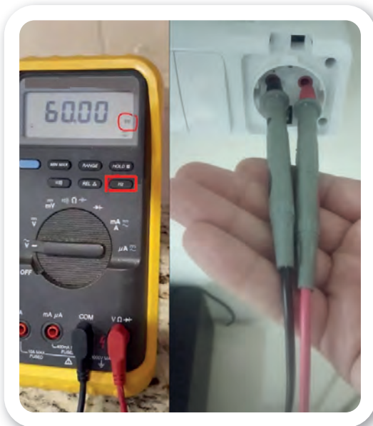
Görsel 17.30: Prizde frekans ölçümü yapılması
