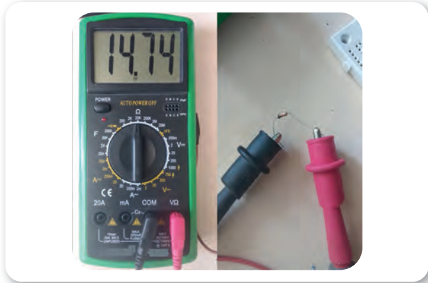
Görsel 17.27: Avometre ile örnek bir direnç ölçümü
