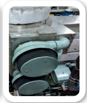
Görsel 13.2: Metal elemanlı filtrenin keçeyle kaplanması
