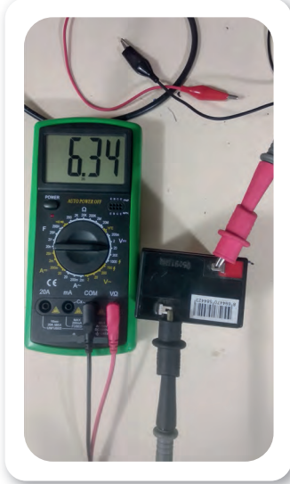
Görsel 17.28: Avometre ile akünün gerilim ölçümü
