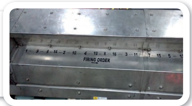
Görsel 12.4: Beraber çalışan pistonlar ve ateşleme sırası
