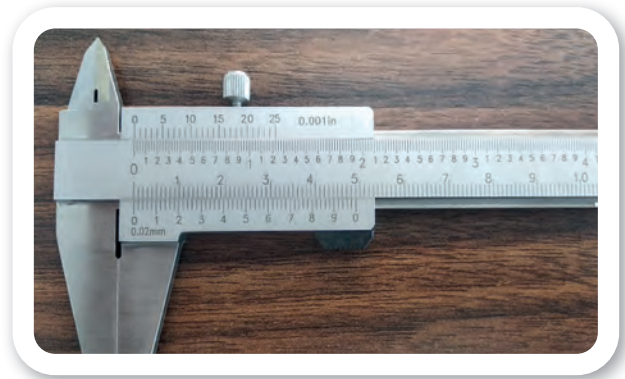
Görsel 11.8: 1/50 (0,02 mm) hassasiyetli mekanik kumpas
