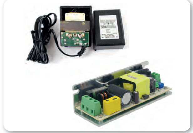
Görsel 18.8: Trafonun DC güç kaynaklarında kullanımı
