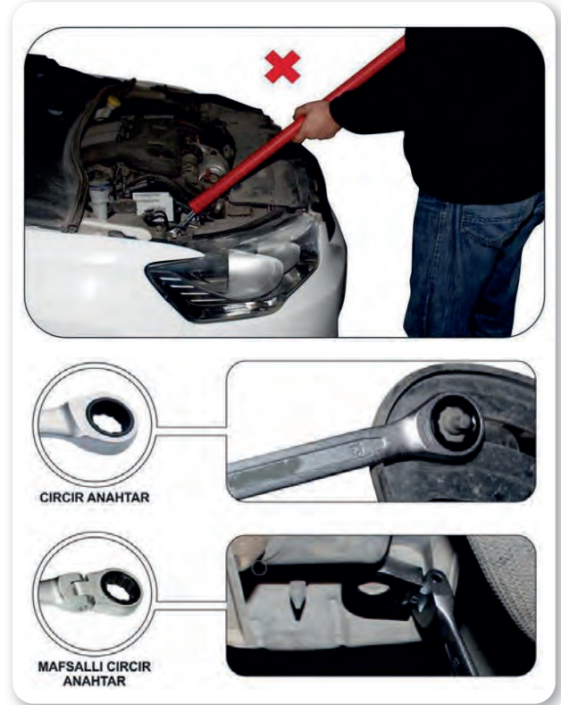
Görsel 10.14: Anahtarların doğru ve yanlış kullanımı
