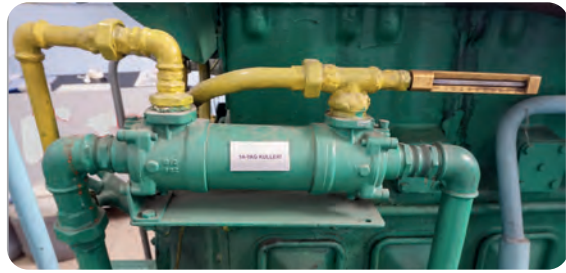
Görsel 15.9: Plakalı ve borulu tip yağ kuleri
