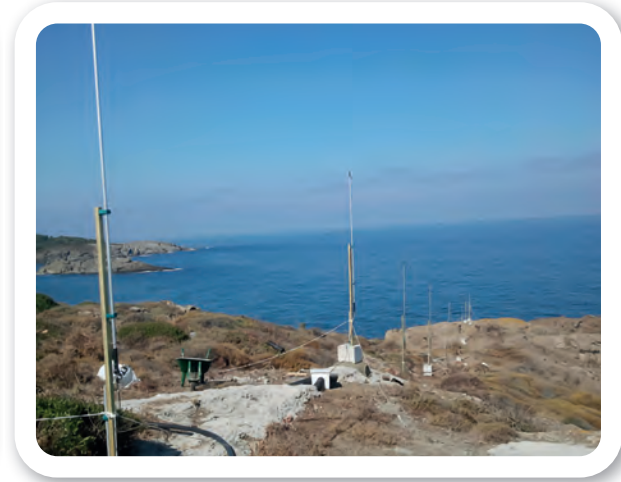
Görsel 6.8: HF Deniz radarı Avrupa yakası alıcı antenleri
