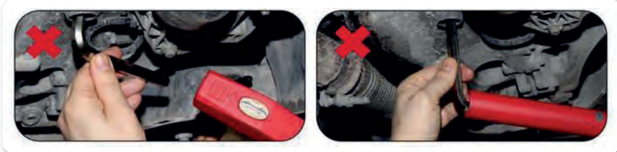
Görsel 10.11: Allen anahtarın hatalı kullanımı
