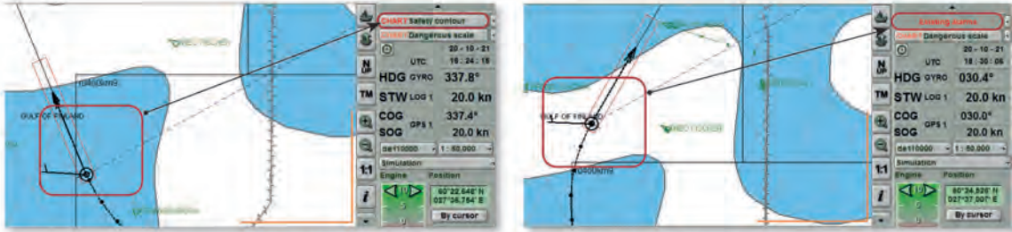
Görsel 8.15: ECDIS'te alarmı tanıma ve alarma uygun hareket etme
