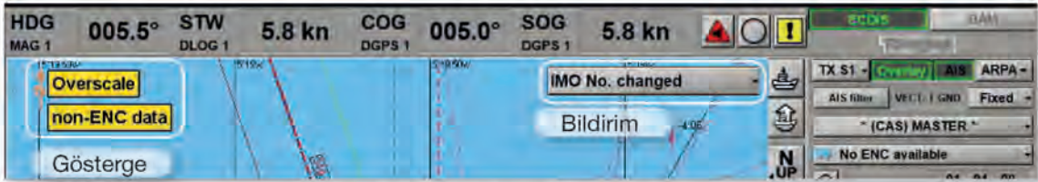
Görsel 8.14: ECDIS'te gösterge ve bildirimlerin görünümü
