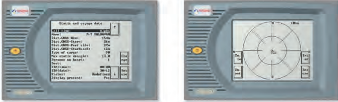
Görsel 7.3: AIS cihazının monitörü
