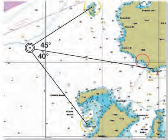
Şekil 1.13: Yatay sekstant (sextant) açısı ve station pointer ile mevki koyma
