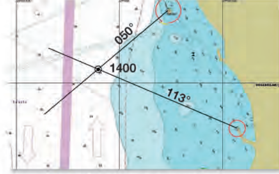
Şekil 1.4: İki kerteriz ile mevki koyma
