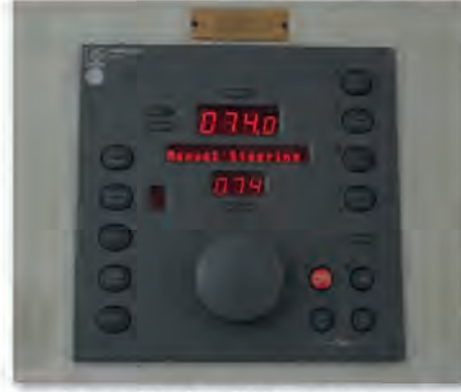
Görsel 7.4: Otopilot kontrol paneli
