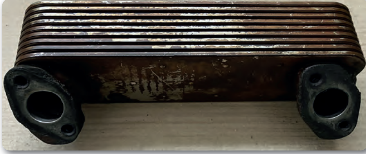
Görsel 1.3: Yağ soğutucu
