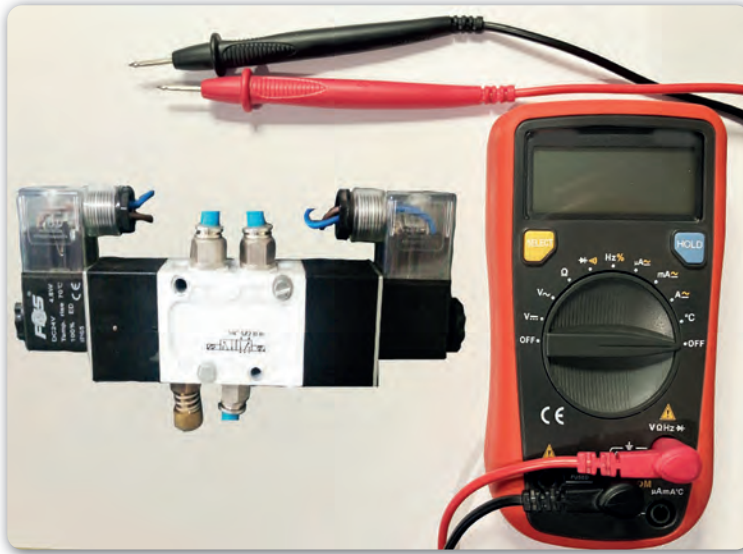
Görsel 4.10: Multimetreyle selenoid valfin bobin kontrolü
