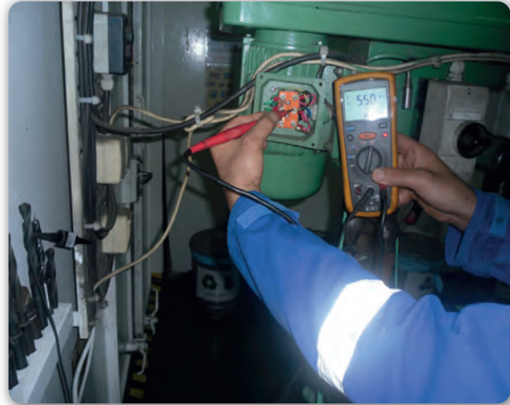
Görsel 5.8: Meger cihazıyla yalıtım direnci ölçümü
