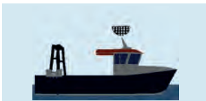
Şekil 10.27: Boyu < 20 m olan, ağ balıkçılığıyla uğraşan bir teknede gündüz işaretinin görünümü
