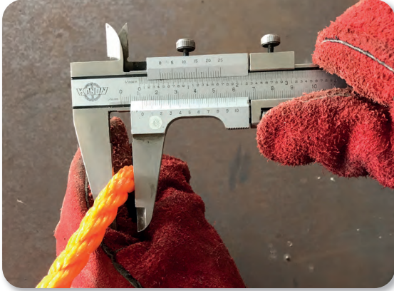
Görsel 2.2: Çap ölçüm aşamaları
