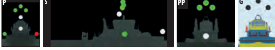
Şekil 10.39: Boyu \geq 50 m, üzerinde yol bulunup mayın tarama işiyle meşgul olan bir teknede fenerlerin görünümü
