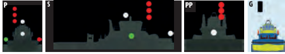
Şekil 10.40: Boyu \geq 50 m, üzerinde yol bulunup su çekimi nedeniyle seyri kısıtlı olan bir teknede fenerlerin görünümü
