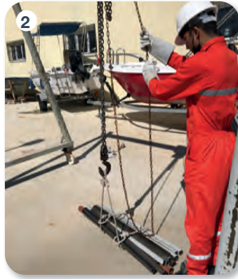
Görsel 4.5: Sapan kullanarak yük kaldırma aşamaları
