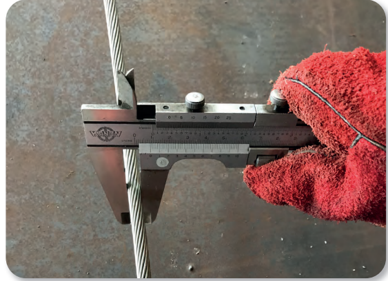
Görsel 2.2: Çap ölçüm aşamaları
