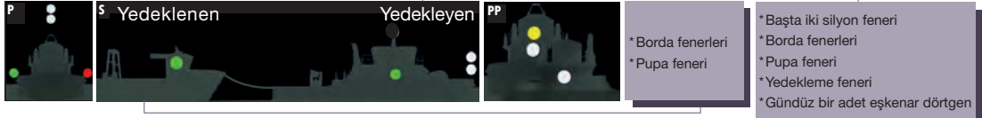
Şekil 10.7: Boyu < 50 m olan teknede yedek boyu < 200 m ise fenerlerin görünümü
