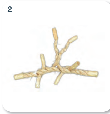
Görsel 2.10: Halatların matiz dikişi ile birleştirilme aşamaları
