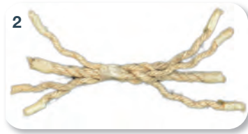
Görsel 2.9: Halatların kolbastı dikişini ile birleştirilme aşamaları
