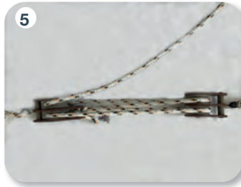
Görsel 4.4: Top palanga oluşturma aşamaları
