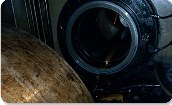
Görsel 1.54: Şaft tüneli ve ana makine pervane şaftı
