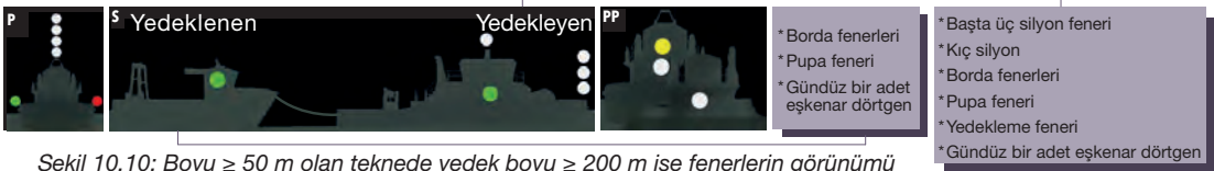
Şekil 10.10: Boyu >= 50 m olan teknede yedek boyu >= 200 m ise fenerlerin görünümü
