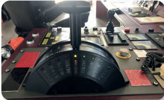
Görsel 6.2: Sabit adım pervaneli gemi makine telgrafı
