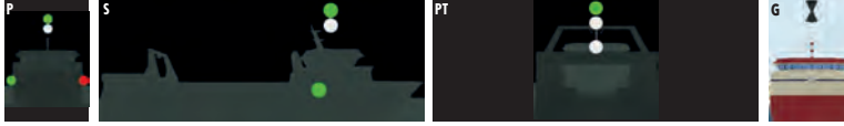
Şekil 10.15: Boyu < 50 m olan, üzerinde yol bulunan ve trol çeken bir teknede fenerlerin görünümü
