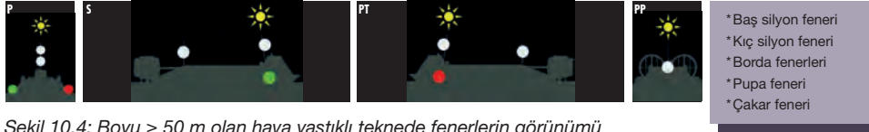
Şekil 10.4: Boyu \geq 50 m olan hava yastıklı teknede fenerlerin görünümü
