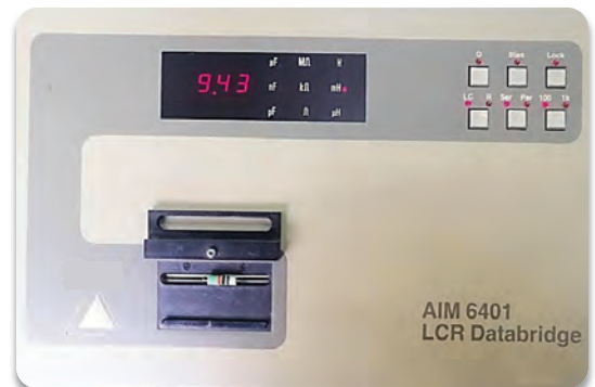
Görsel 1.36: LCRmetre ile endüktans ölçümü
