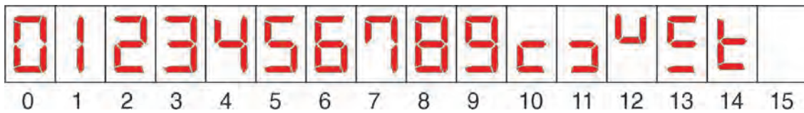
Şekil 4.44: BCD 7 segment kod çözücü devresi çıkışında 7 segmentli displayde gözlenen değerler
