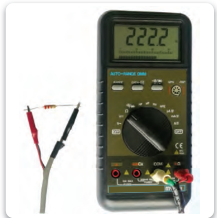
Görsel 1.21: Multimetre ile direnç ölçme
