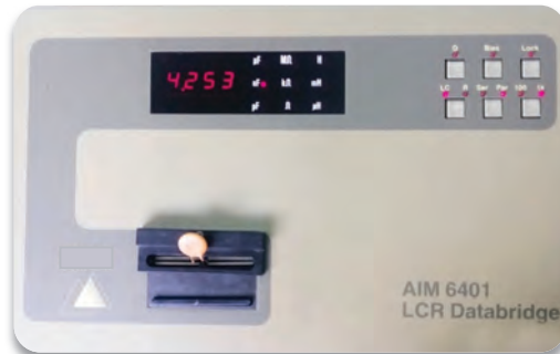
Görsel 1.26: LCRmetre ile kapasite ölçümü
