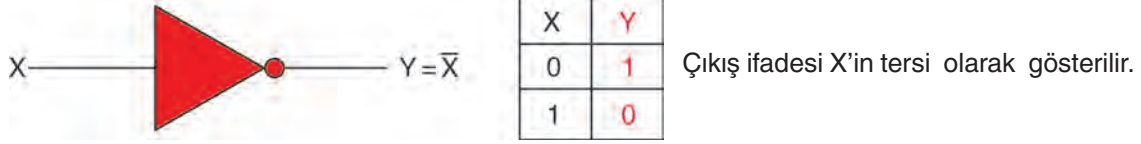
Şekil 4.7: DEĞİL (NOT) kapısı sembolü ve doğruluk tablosu
