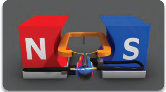
Görsel 1.1: Alternatif akım elde edilmesi (alternatör modeli)
