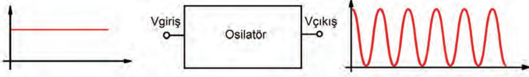
Şekil 6.1: Osilatör blok şekli ve giriş-çıkış dalga şekilleri
