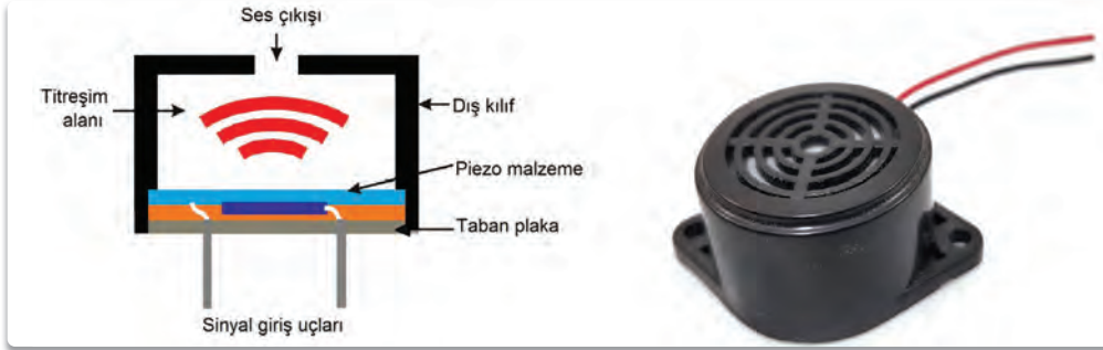
Şekil 6.15: Piezoelektrik hoparlör ve yapısı
