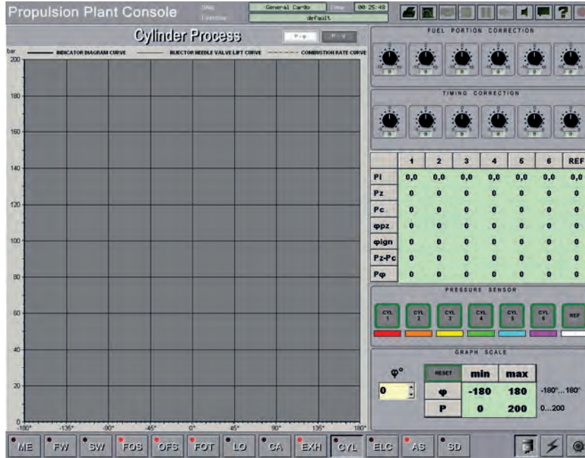
Görsel 1.47: Silindirlerdeki yanma kontrolü simülâtör ekran görüntüsü
