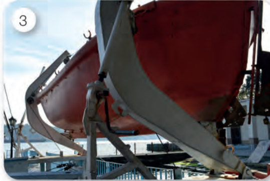
Görsel 5.15: Açık can filikasının metaforaya alınması
