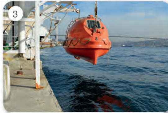
Görsel 5.8: Tam kapalı can filikasının mayna aşamaları
