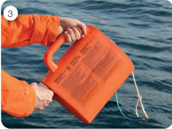
Görsel 4.24: Halat atma aletini kullanma aşamaları
