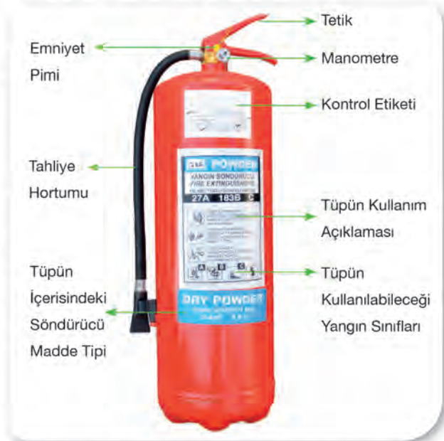
Görsel 3.8: Taşınabilir yangın tüpünün kısımları
