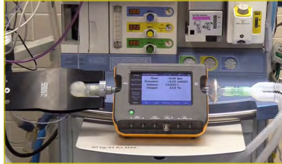
Görsel 4.21: Anestezi cihazı ventilatör kalibrasyonu
