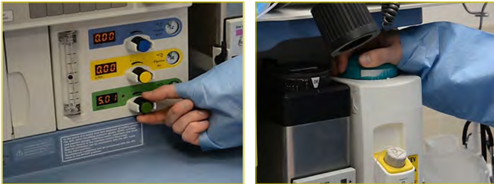
Görsel 4.23: Vaporizatör kalibrasyonu için flowmetre ve vaporizatörün ayarlanması
