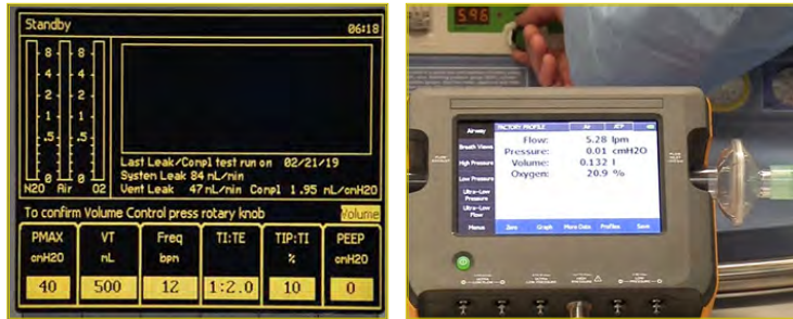
Görsel 4.22: Anestezi cihazının kalibrasyon için ayarlanması
