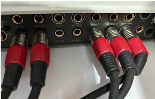
Görsel 8.4.a: Odyometre cihazı jak bağlantıları
