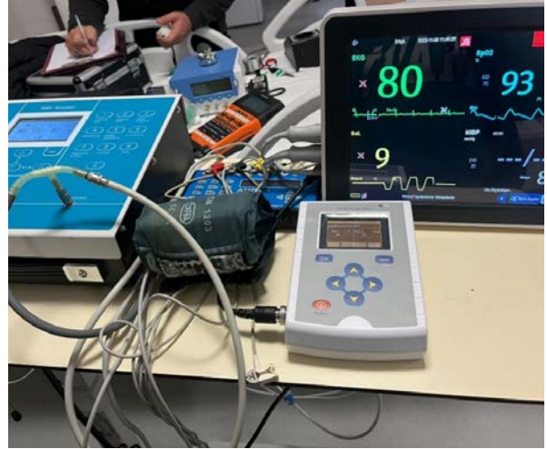
Görsel 5.19: HBM cihazının kalibrasyonu
