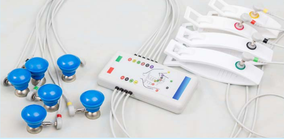
Görsel 1. 36: Avrupa standardına göre hasta kablosunun bağlantı renkler kodlaması ve elektrot bağlantıları
