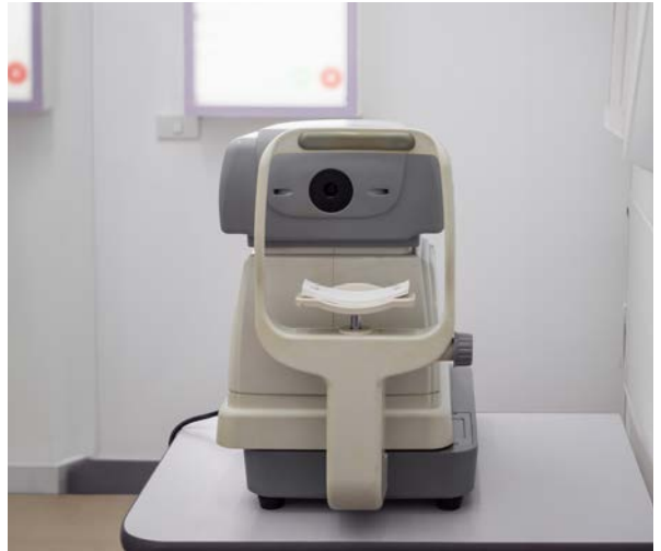
Görsel 9.7: Otofrefraktometre cihazının çene dayanağı ünitesi
