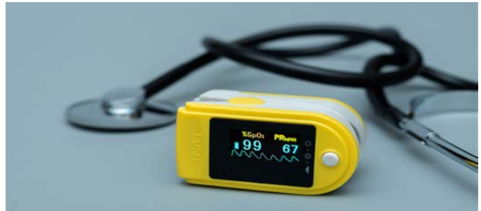
Görsel 1.49: Kardiyotakometre sistemine sahip SpO 2 cihazı
