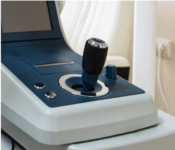
Görsel 9.6: Otofrefraktometre cihazının kontrol kolu
