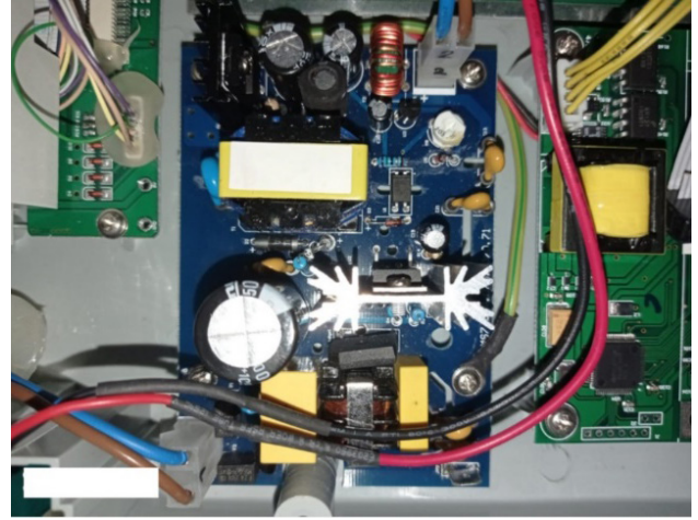
Görsel 1.46: EKG cihazının üzerinde bulunan SMPS güç kaynağı kartı
