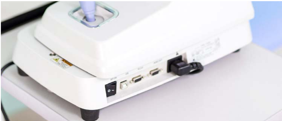
Görsel 9.10: Otofrefraktometre cihazının bağlantı noktaları
