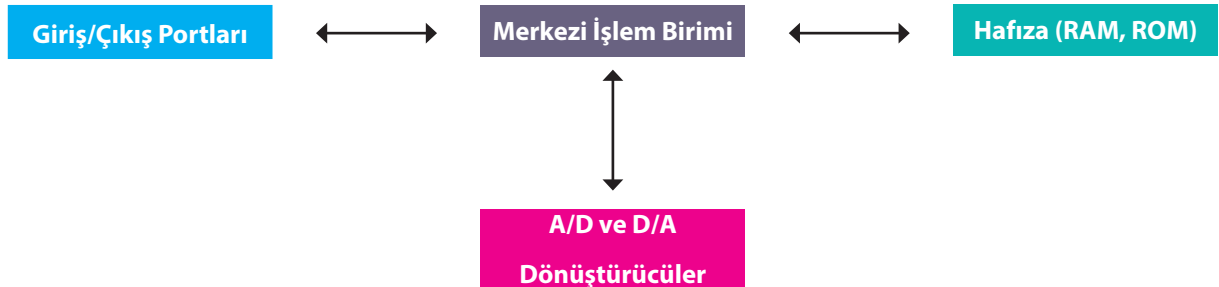
Görsel 2.2: Mikrodenetleyicinin iç yapısı
