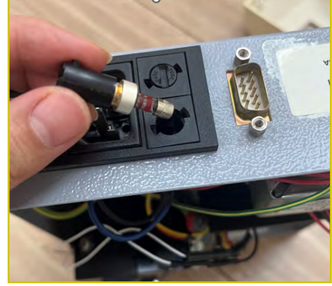
Görsel 5.15: Koagulometre cihazının sigorta değişimi
