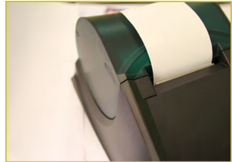
Görsel 5.16: Termal kâğıdın yerleştirilmesi
