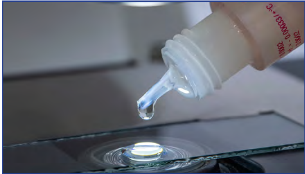
Görsel 6.6: İmmersiyon yağıyla numune görüntüleme
