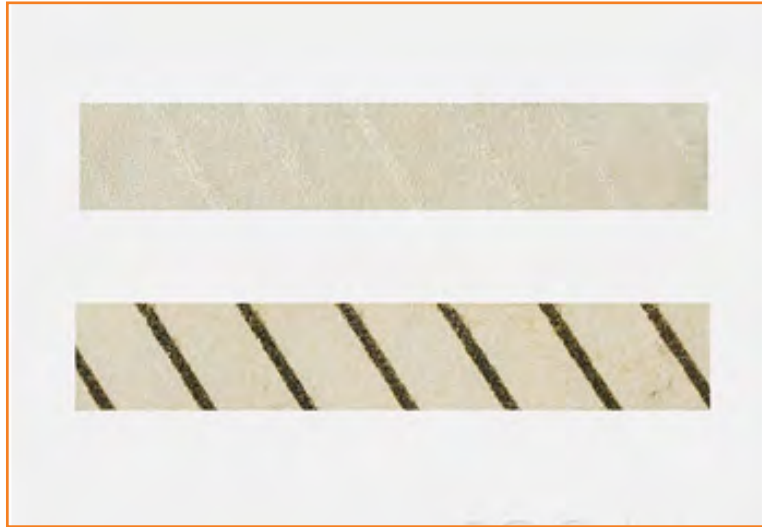
Görsel 9.12: Üstte işlem görmemiş, altta işlem görmüş indikatör bandı
