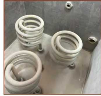
Görsel 4.8: Kaynama kazanında bulunan rezistanslar
