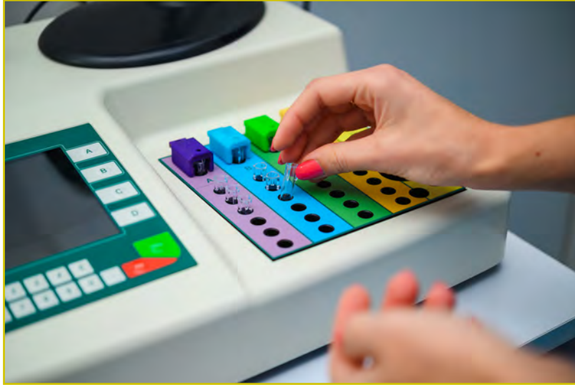
Görsel 5.6: Bekleme ve okuma bloklarına tüplerin yerleşimi
