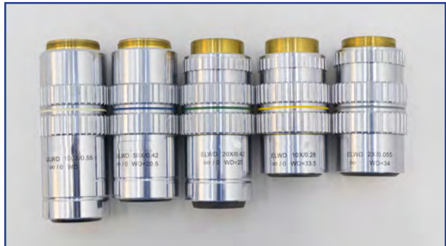
Görsel 6.3: Mikroskoplara monte edilip sökülebilen özellikte, farklı büyütme kapasiteli çeşitli objektif lensler
