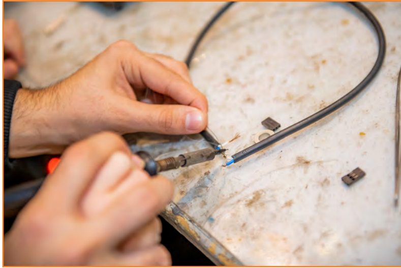
Görsel 9.8: Kablo lehimleme
