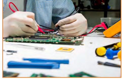
Görsel 6.10: Ölçü aletiyle gerilim ölçümü
