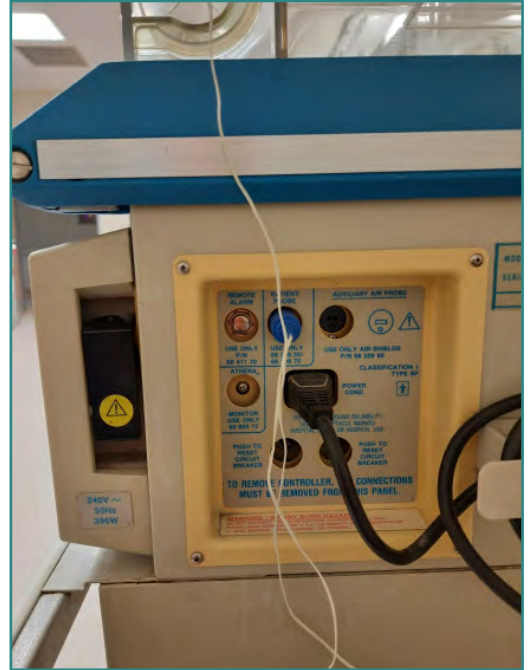
Görsel 5.12: Kuvöz cihazı hasta probu ve diğer bağlantı girişleri
