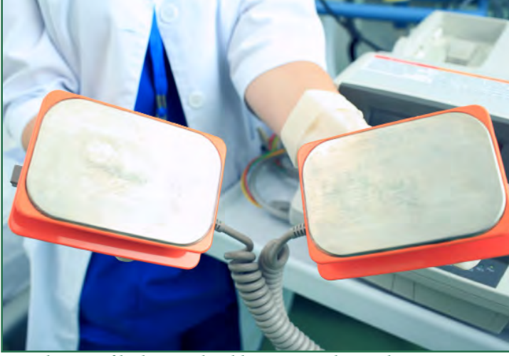
Görsel 2.7: Defibrilatörün kaşıklarının metal yüzeyleri
