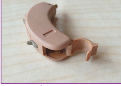
Görsel 3.17: İşitme cihazı pil yerleştirilen kısım
