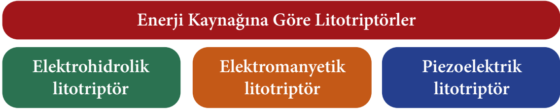
Görsel 4.10: Enerji kaynağına göre litotriptörler
