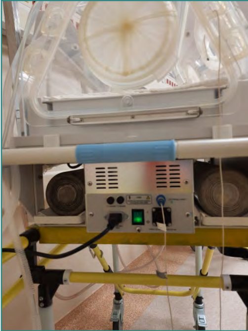
Görsel 5.11: Kuvöz cihazı açma-kapama anahtarı ve güç kablosu
