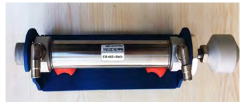
Görsel 3.46: Tek etkili silindir ve sembolü
