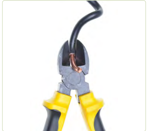
Görsel 1.8: İletkenlerin yüzeyindeki yalıtkanların soyulması
