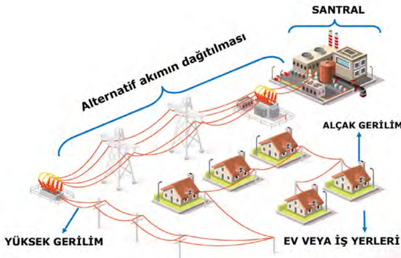
Görsel 1.119: Alternatif akımın üretimi ve dağıtılması
