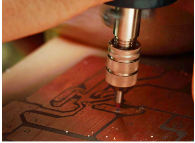
Görsel 2.12 El matkabı ile delme işlemi
